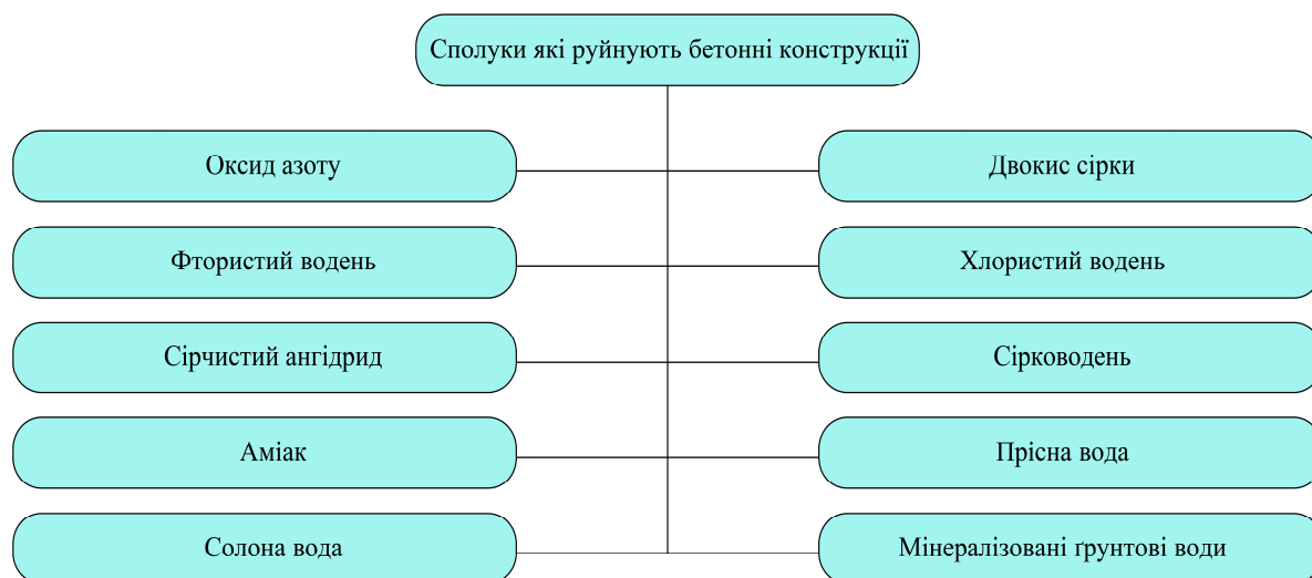
Рис 2 – Сполуки, що руйнують будівельні конструкції
