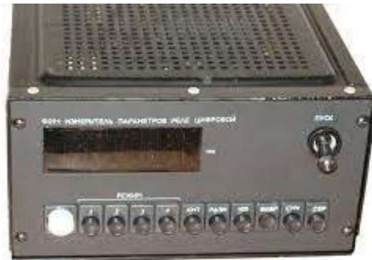
Рисунок 1.6 – Зовнішній цифровий вимірювач часових параметрів реле Ф291
