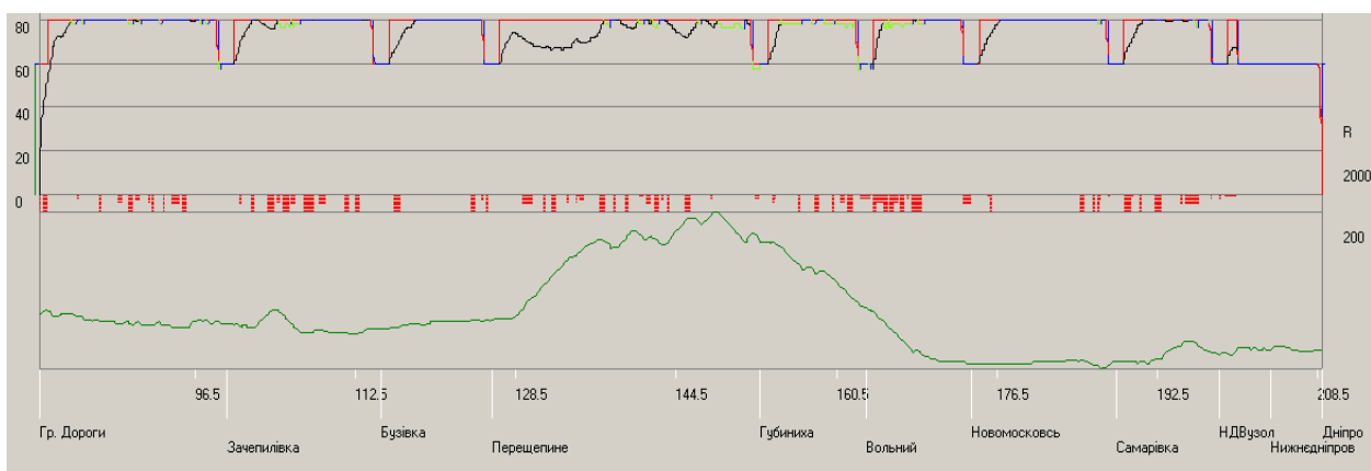
Рис. 5.2. Графічні результати тягових розрахунків (знизу доверху: поздовжній профіль, план лінії, крива швидкості руху)
