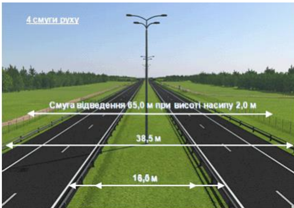
Рис. 1.1. Смуга відведення ділянки автомобільної дороги
