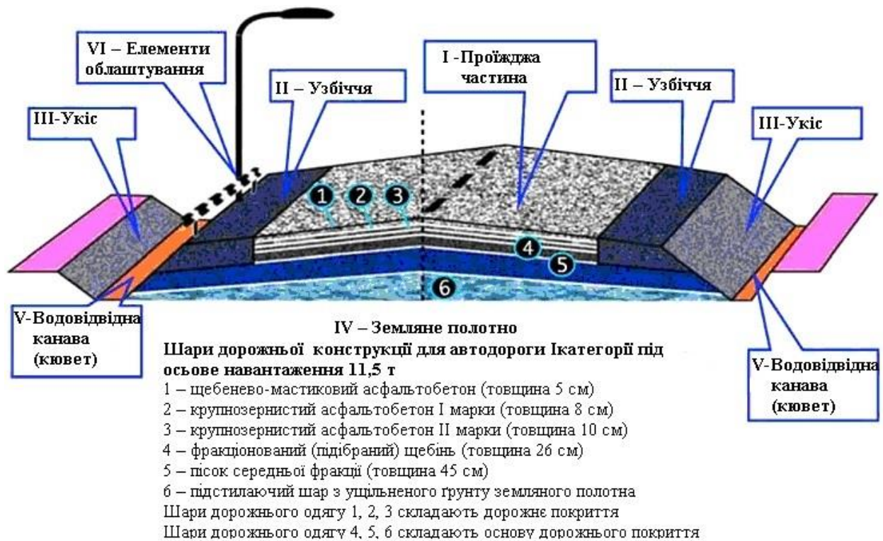
Рис 1.2. Конструкція автомобільної дороги
