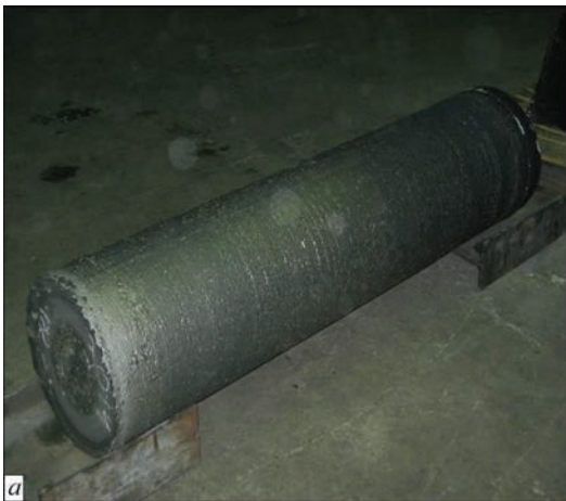
Рис. 7. Готові зливки діаметром 400 мм із жароміцних сплавів: а — ХН60ВТ; б — ХН38ВТ
