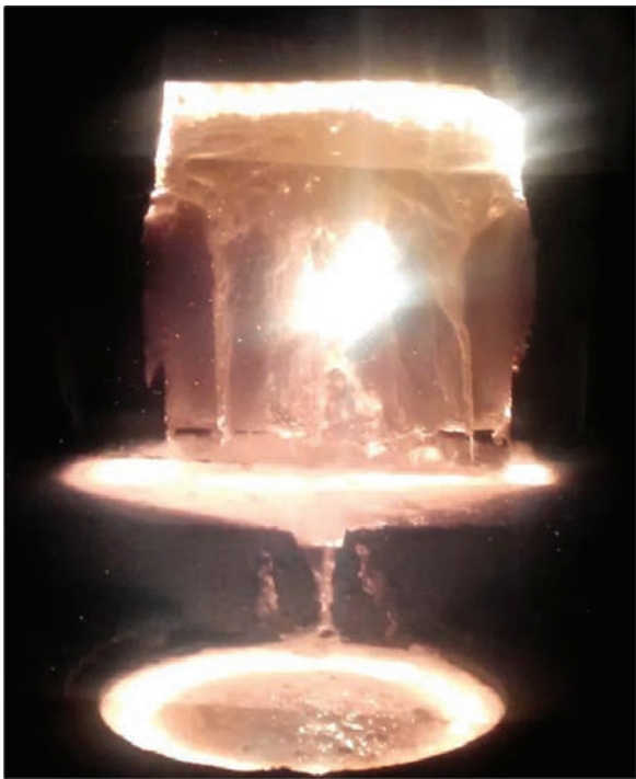
Рис. 6. Плавлення шлаку, що міститься у вихідній шихтовій заготовці
