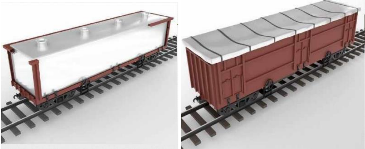
Рисунок 12- Загальний вигляд перевезення зерна в піввагоні при застосуванні одноразових та багаторазових тентів
