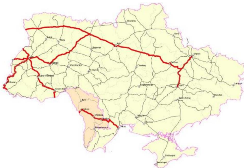
Рисунок 31 – Пропонований план прокладання колії шириною 1435 мм
