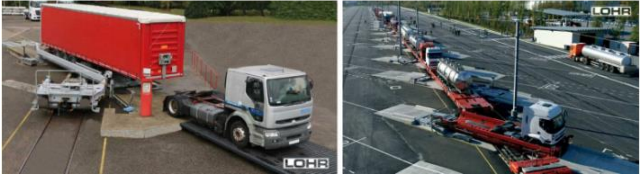
Рисунок 17 – Технологія швидкого формування контрейлерного поїзда
