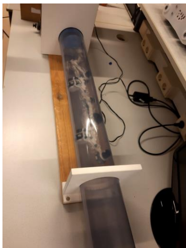
Рис. 5. Фізична модель діагностування стану трубопроводу, лабораторія RAM, Університет Твенте, Нідерланди
