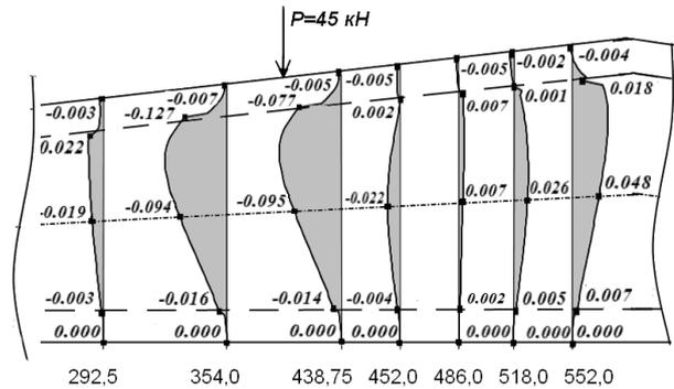
Рис. 2. Расчетная схема балки и эпюры напряжений  $\sigma_y$  по высоте сечений
