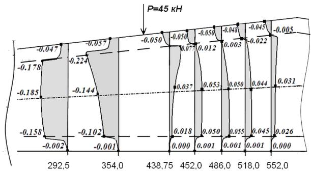
Рис. 3. Распределение касательных напряжений  $\tau_{xy}$  в сечениях
