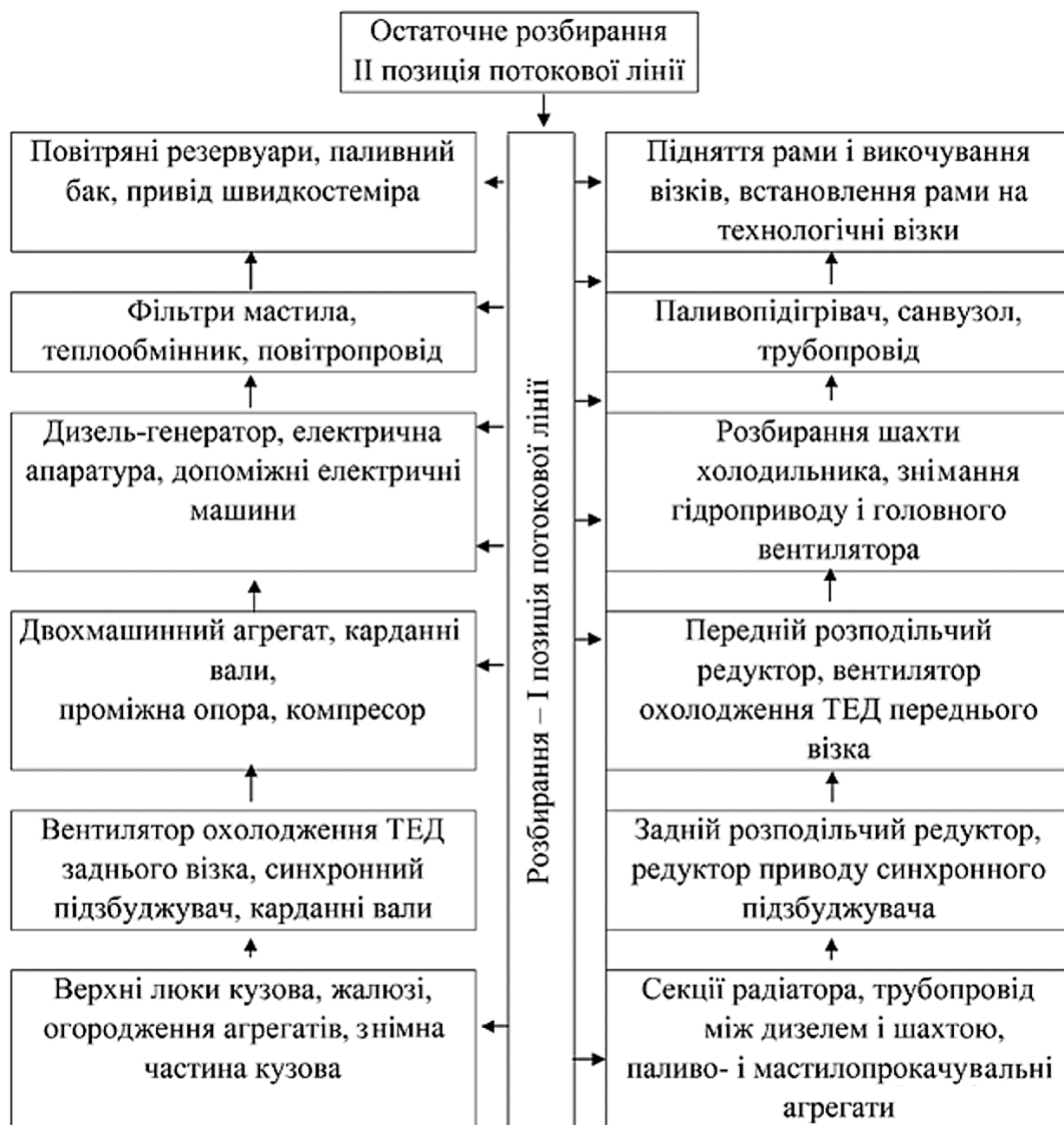
Рис. 3.4. Схема розбирання секції тепловоза серії 2TE10Л
