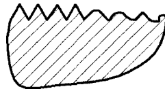
Рис. 8.3. Схема руйнування різьби на окремих ділянках
