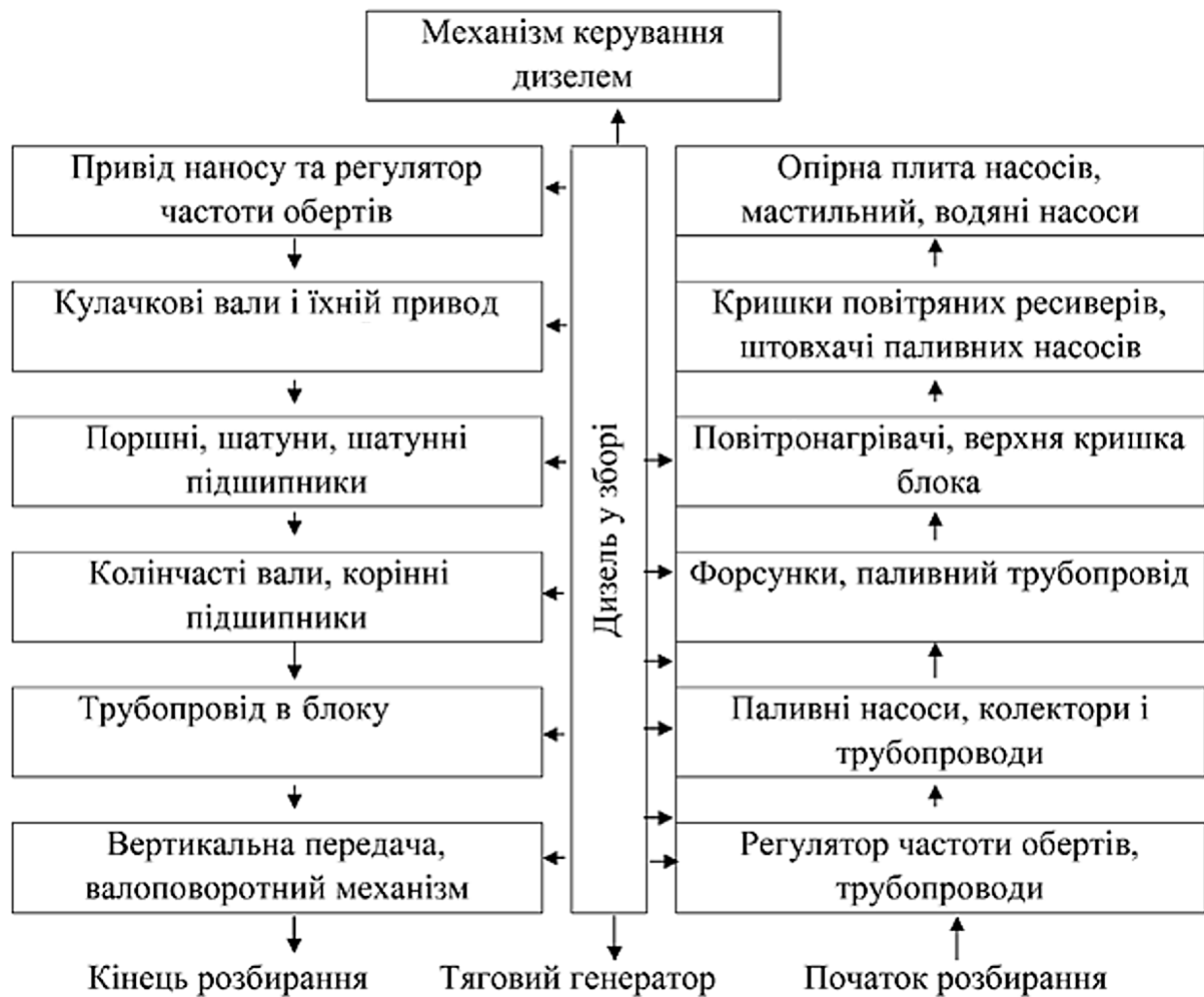
Рис. 3.5. Схема розбирання дизеля типу 10Д100
