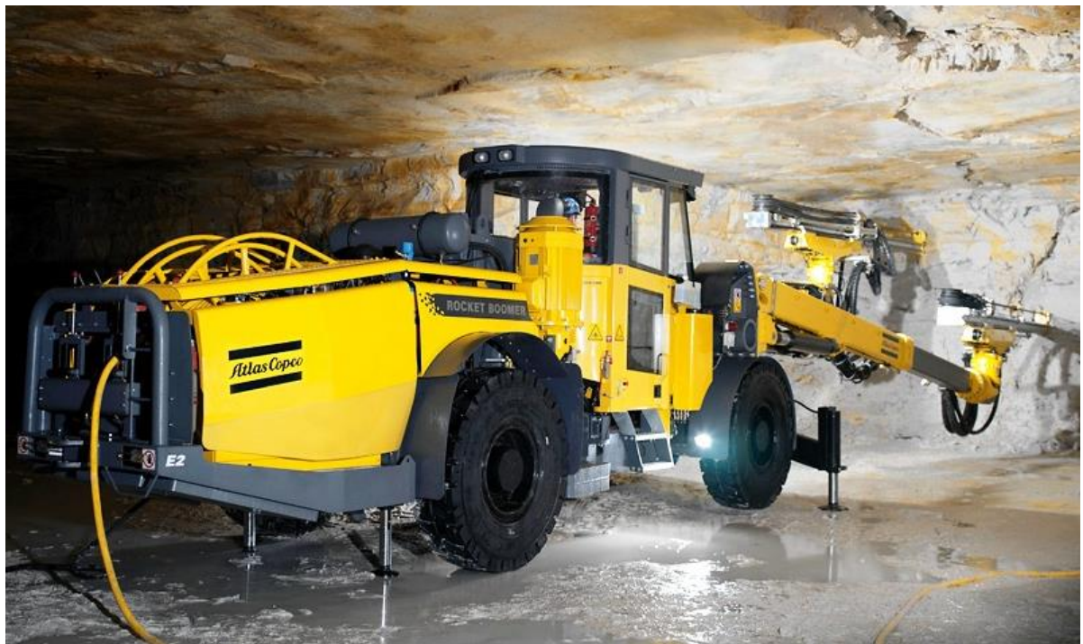
Рисунок 2.2 – Бурова установка Boomer M2C при роботі в тунелі Технічна характеристика установки наведені в табл. 2.1
