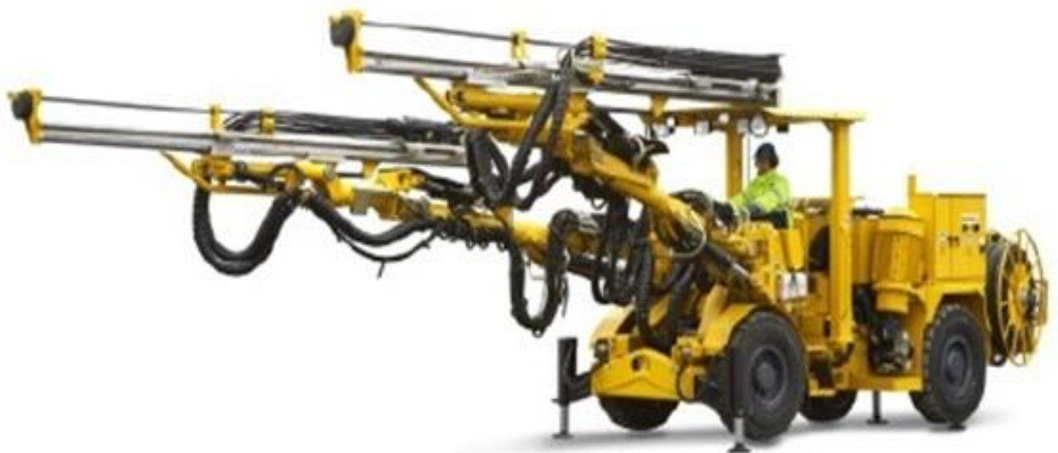
Рисунок 2.3 – Бурова електрогідролічна установка Boomer 282 Технічна характеристика бурової установки наведені в табл. 2.2
