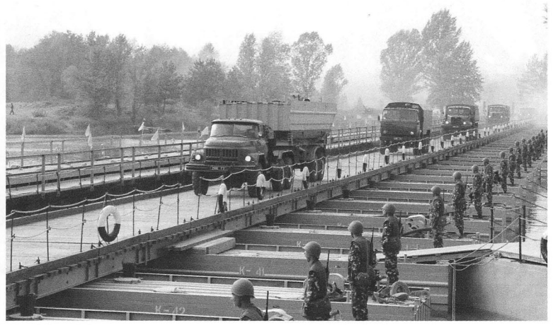
Випробування наплавного моста рухомим складом
