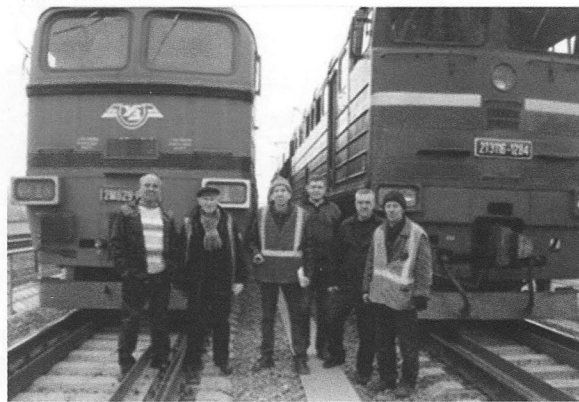
Випробувальне навантаження — локомотиви 2Т3116 та 2М629 із вагою на вісь 23 та 21 т
