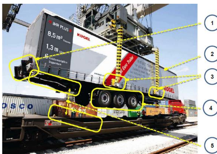
Рисунок 21 – Конструктивні особливості напівпричепа, придатного для вертикального перевантаження: 1 – відкидний протипідкатний буфер; 2 – посилене кріплення даху; 3 – отвори для кліщових захватів, окантовка тенту навколо отворів, посилена рама; 4 – визначене положення візка на рамі; 5 – профіль рами, відповідний профілю вагона
