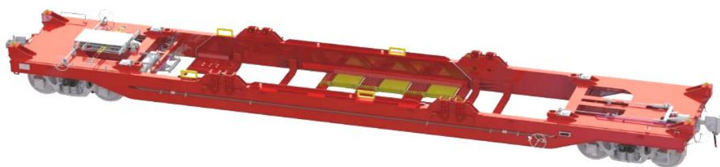
Рисунок 4 – Загальний вигляд вагона-платформи моделі 13-6987 з «корзиною»
