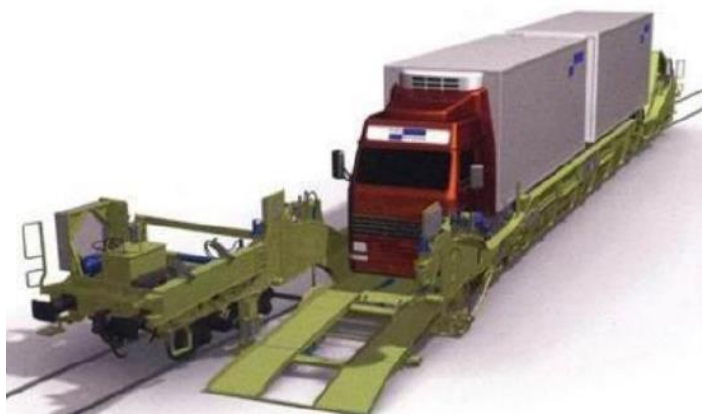
Рисунок 14 – Вагон-платформа системи «Flexiwagon» з встановленим на ньому автопоїздом
