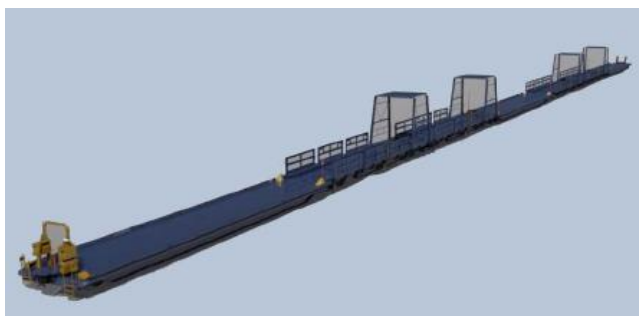
Рисунок 13 – Вагон системи «Ro-La», який використовується для перевезень автопоїздів в Євротунелі
