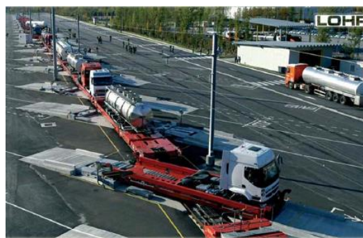
Рисунок 11 – Термінал системи «Modalohr»: а – завантаження напівпричепи; б – завантаження тягача
