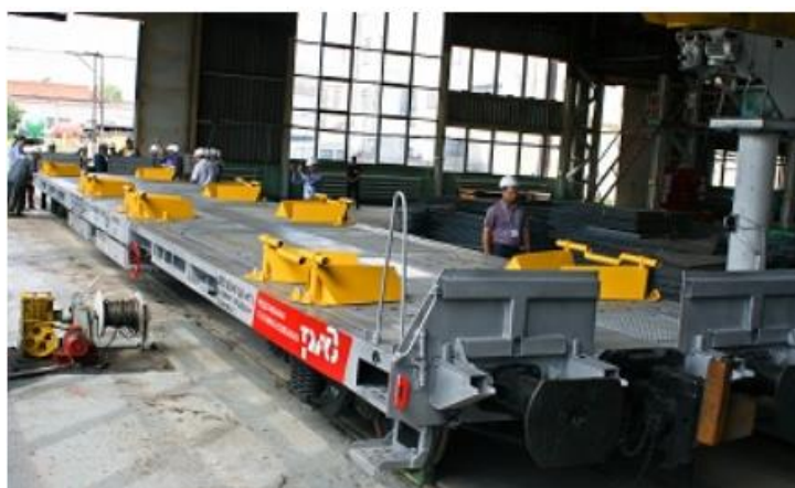
Рисунок 1 – Спеціалізований вагон-платформа моделі 13-9961 [19]
