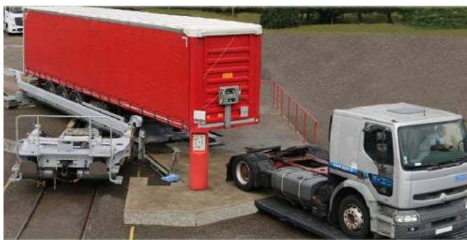
Рисунок 11 – Термінал системи «Modalohr»: а – завантаження напівпричепи; б – завантаження тягача
