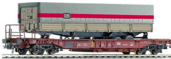
Рисунок 20 – Універсальний вагон-платформа, яка використовується в технології «Lo-Lo»
