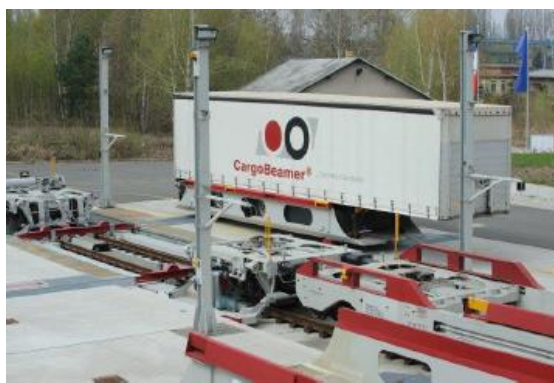
Рисунок 6 – Процес завантаження напівпричепи на платформу за технологією «CargoBeamer»: а – напівпричіп на палеті; б – переміщення палети з напівпричепом
