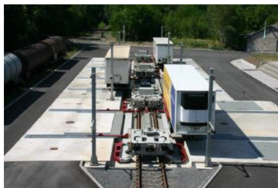
Рисунок 6 – Процес завантаження напівпричепи на платформу за технологією «CargoBeamer»: а – напівпричіп на палеті; б – переміщення палети з напівпричепом
