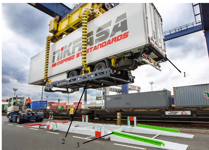
Рисунок 22 – Обробка неcranового напівпричепа за допомогою системи «NiKRASA»: 1 – напівпричіп; 2 – транспортний майданчик; 3 – термінальний майданчик
