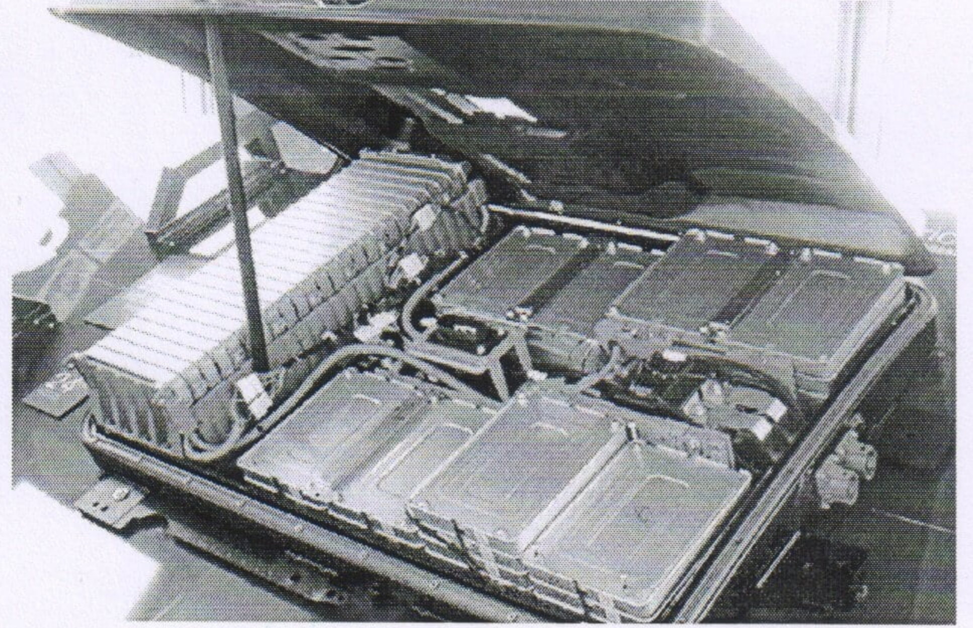
Внутрішня будова тягової акумуляторної батареї електромобіля Nissan Leaf
