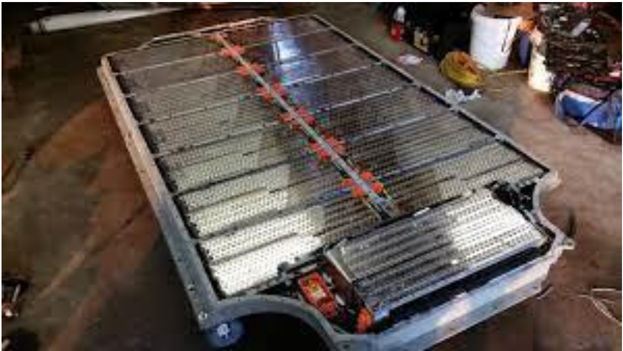
Рис.1.5 - Батарея електромобіля Tesla Model S у розрізі.
