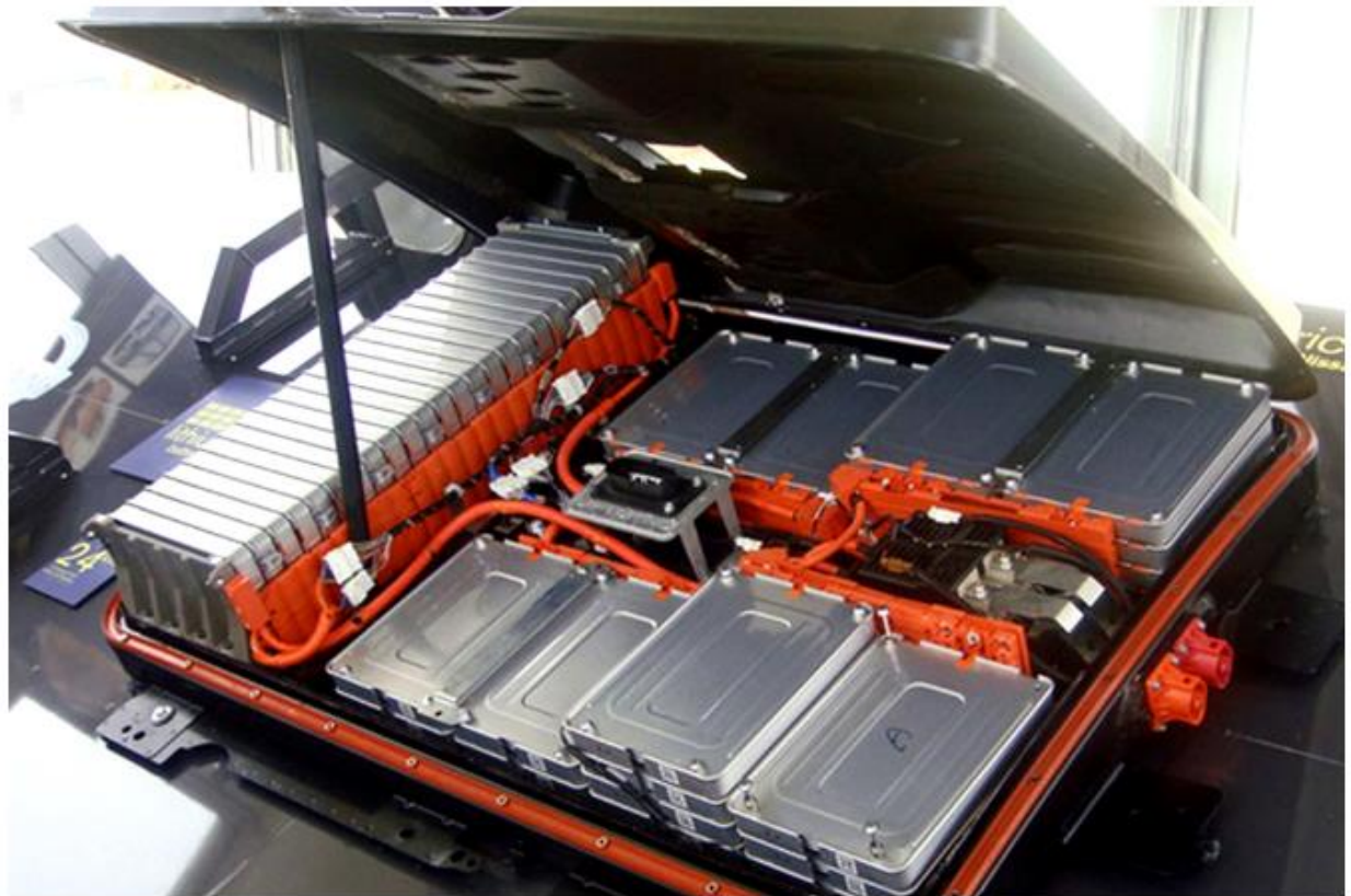
Рис.1.2 - Внутрішня будова тягової акумуляторної батареї електромобіля Nissan Leaf
