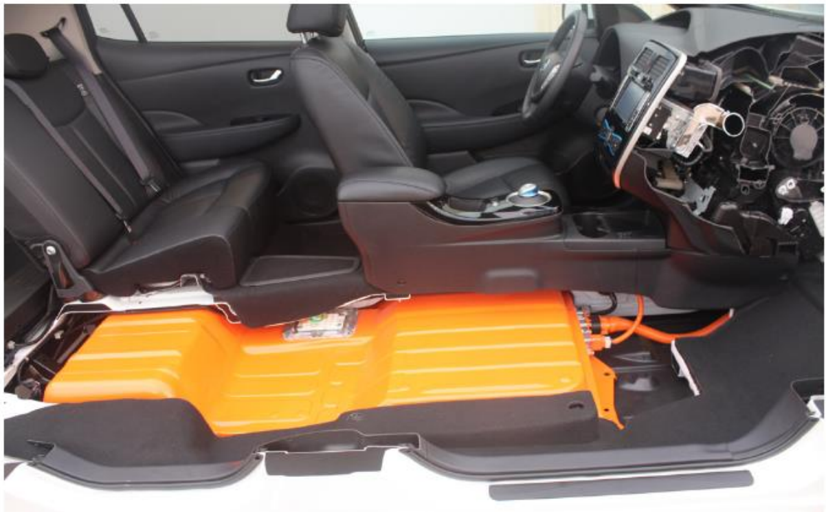
Рис. 1.1 - Розташування батареї на електромобілі Nissan Leaf.
