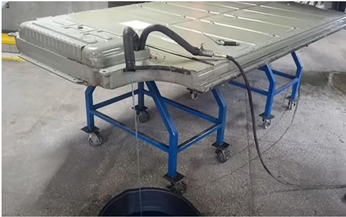
Рис.1.8 - Скидання охолоджуючої рідини батареї електромобіля Tesla Model S при ремонті.
