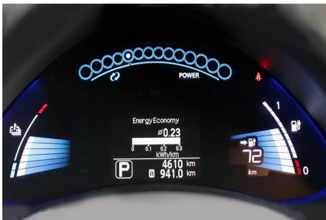
Рис. 1.3 - Блок індикації стану тягової батареї електромобіля Nissan Leaf.
