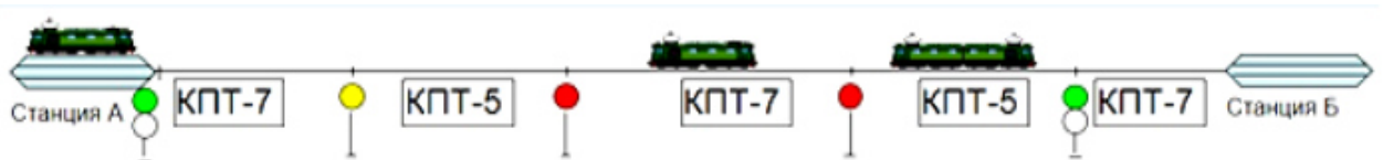
Рисунок 1.4 – Розташування кодових колійних трансмітерів на перегоні
