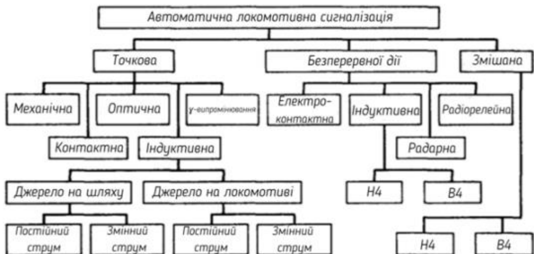
Рисунок 1.2 – Класифікація систем автоматичної локомотивної сигналізації
