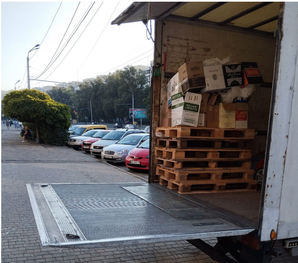
Рис. 1.12 Самонавантажувач з заднім вантажним бортом
