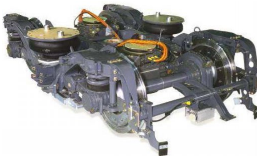
Рисунок 3.2 – Моторний візок поїзда ICE 3
