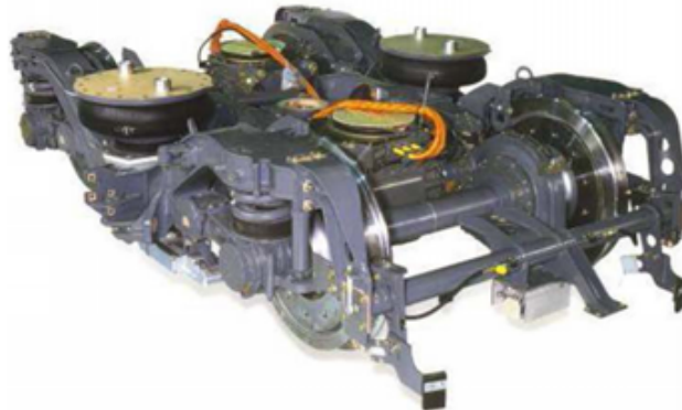
Моторний візок поїзда ICE 3
