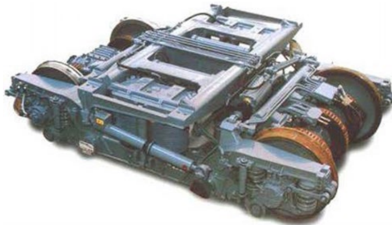
Рисунок 3.4 – Немоторних візок поїзда ICE-T з механізмом нахилу кузова
