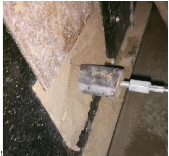
Рис. 2.13. Загальний вигляд станда: а) – Креслений та габаритні розміри; б) – Вимірювальна система; в) – Процес впровадження робочого органу в ґрунт. 1 – короб; 2 – робочі канати; 3, 4, 5, 6, 10 – блоки, що відхиляють; 7 – силовий тензOMETричний датчик; 8 – ваговий термінал; 9 – лінія числового зв'язку з ПК; 11 – канатний барабан; 12 – редуктор; 13 – клинопасова передача; 14 – електродвигун; 15 – магнітний пускач; 16 – частотний перетворювач; 17 – резистор керування частотним перетворювачем; 18 – розетка живлення вагового терміналу та ПК
