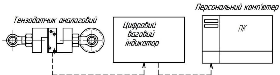
Рис. 2.14. Принципова схема вимірювального вузла
