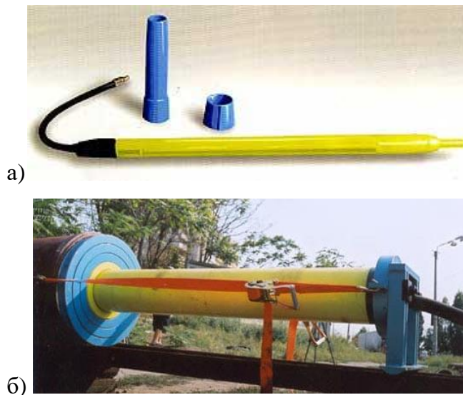
Рис. 1.9. Пневмопробійники: а) – пневмопробійник реверсивний ПП-4605А; б) – машини для забивання труб СО-166.
