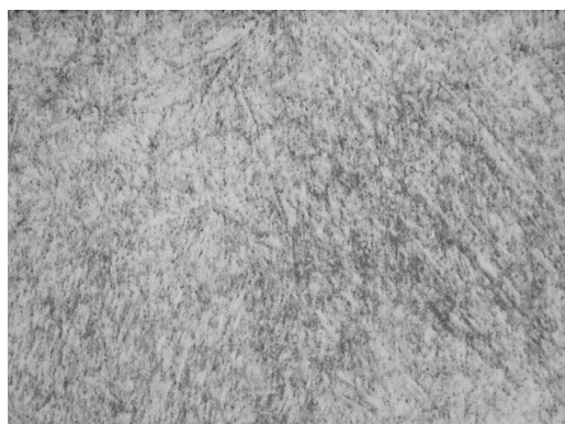
б) Мартенсит відпущений, аустеніт залишковий і карбіди
