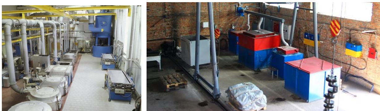
Рис. 5. Схема технологічної лінії карбонітрації
