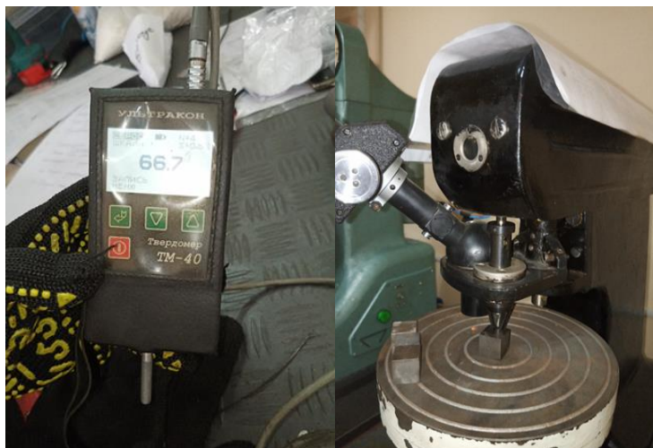
Рис. 7. Замір твердості після карбонітрації
