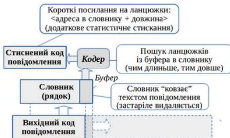
Рисунок 2.4 Схема стиснення зі «ковзаючим словником»
