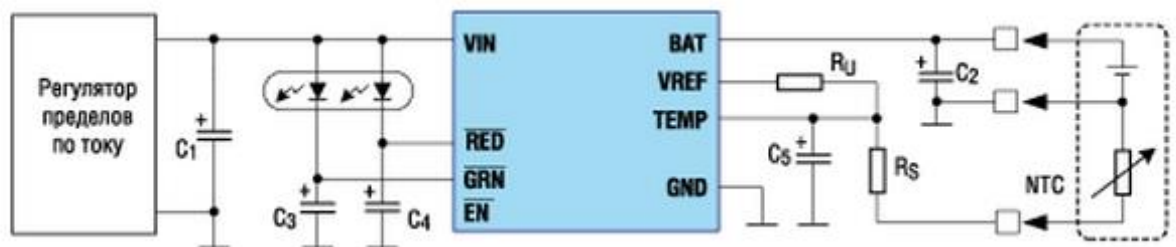
Малюнок В.5 - Підключення акумулятора з внутрішнім NTC-термістором
