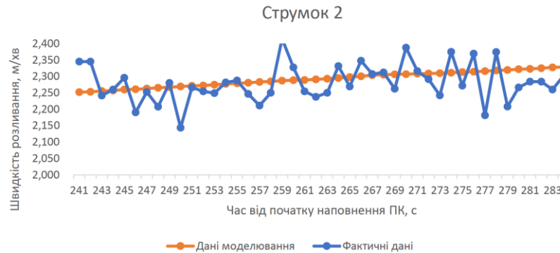
Рис.8 Порівняння фактичної швидкості розливання струмка №2 з даними моделювання
