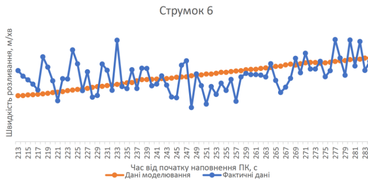
Рис.5 Порівняння фактичної швидкості розливання струмка №6 з даними моделювання
