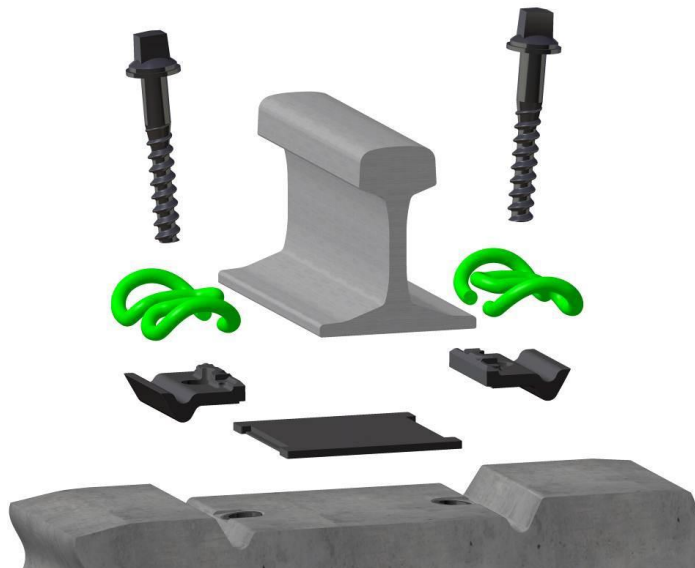
Рис. 4.7. Скріплення типу SBS W SL-1-900-R65 компанії «SCHWING».
