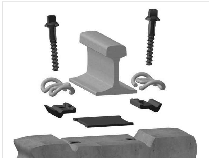
Рис. 4.6. Скріплення типу System W 21 фірми «Vossloh» (регулюючого типу до 1535 мм)
