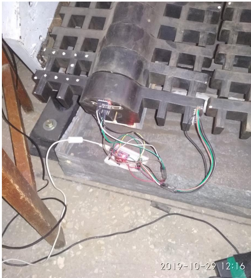
Рисунок 3 – Установка еластичного карткового елемента просіючої поверхні, на вібраційному грохоті
