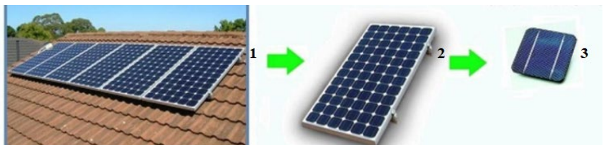
Рис. 2.3. Формування сонячної батареї із базових фотоелементів
