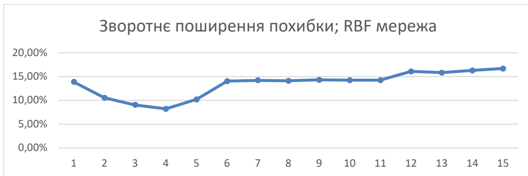
Рисунок 4.7 – Похибка прогнозування в залежності від кількості нейронів у прихованому шарі (BP;RBF)
