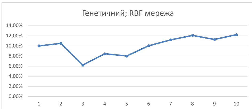
Рисунок 4.8 – Похибка прогнозування в залежності від кількості нейронів у прихованому шарі (Genetic;RBF)
