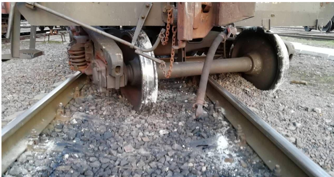
Рисунок 3.21 - Наслідки від невірного вкладання гальмівного башмака 03.04.2018 на станції Знам'янка регіональної філії «Одеська залізниця»
