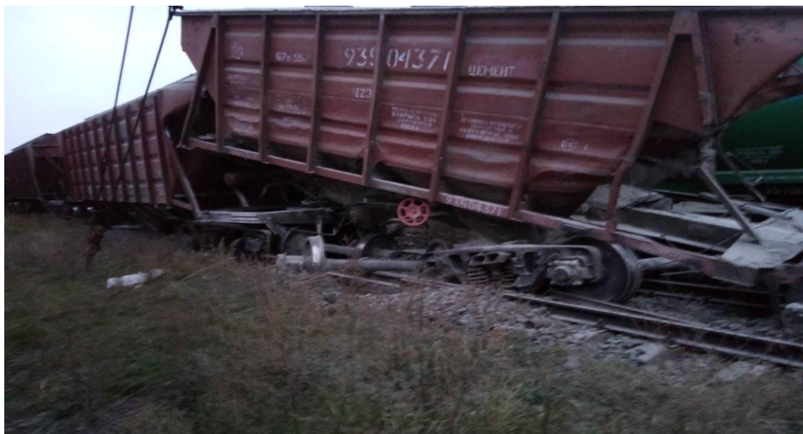
Рисунок 3.22 - Наслідки від нерозрахункового гальмування відцепу допущеного 14.11.2018 на станції Роздільна-Сортувальна регіональної філії «Одеська залізниця»
