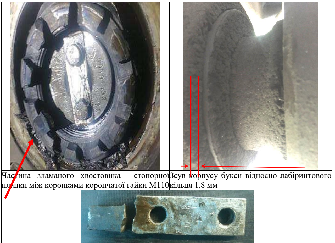
Рисунок 2.10 - Проворот внутрішнього кільця переднього підшипника
