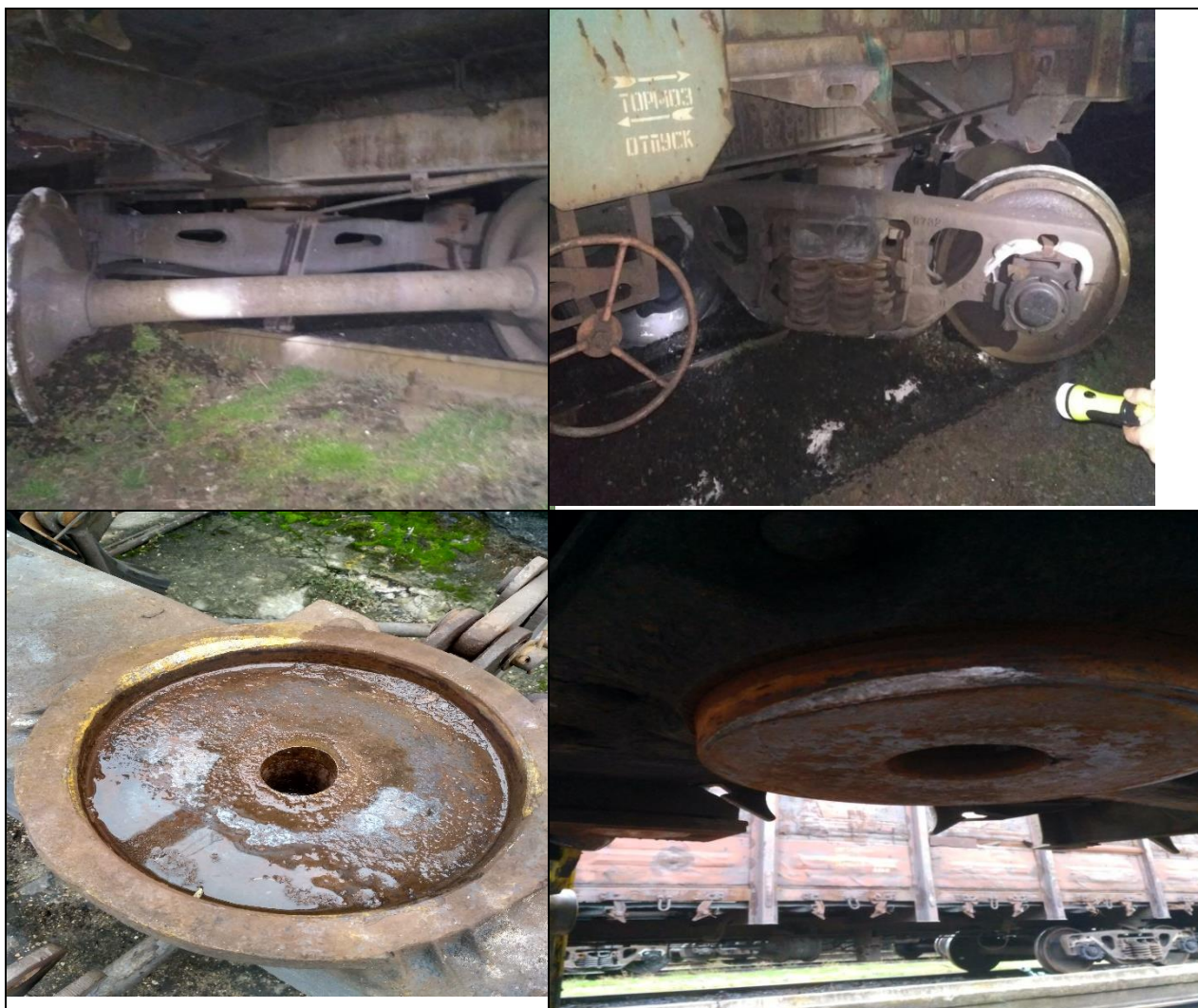
Рисунок 2.12 - Вихід п'ятника з циліндричної поверхні підп'ятника, вигину шворня
