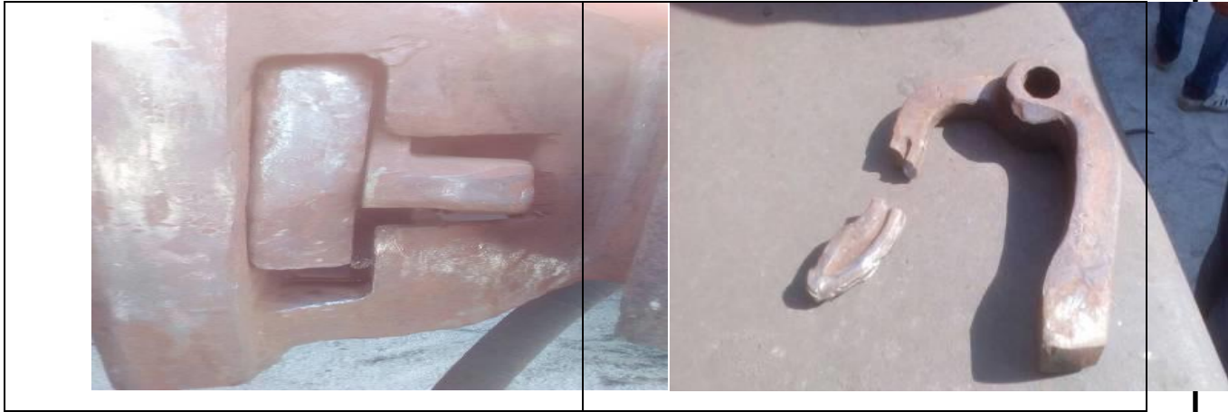
Рисунок 2.15 - Злам нижнього плеча запобіжника від саморозчеплення
