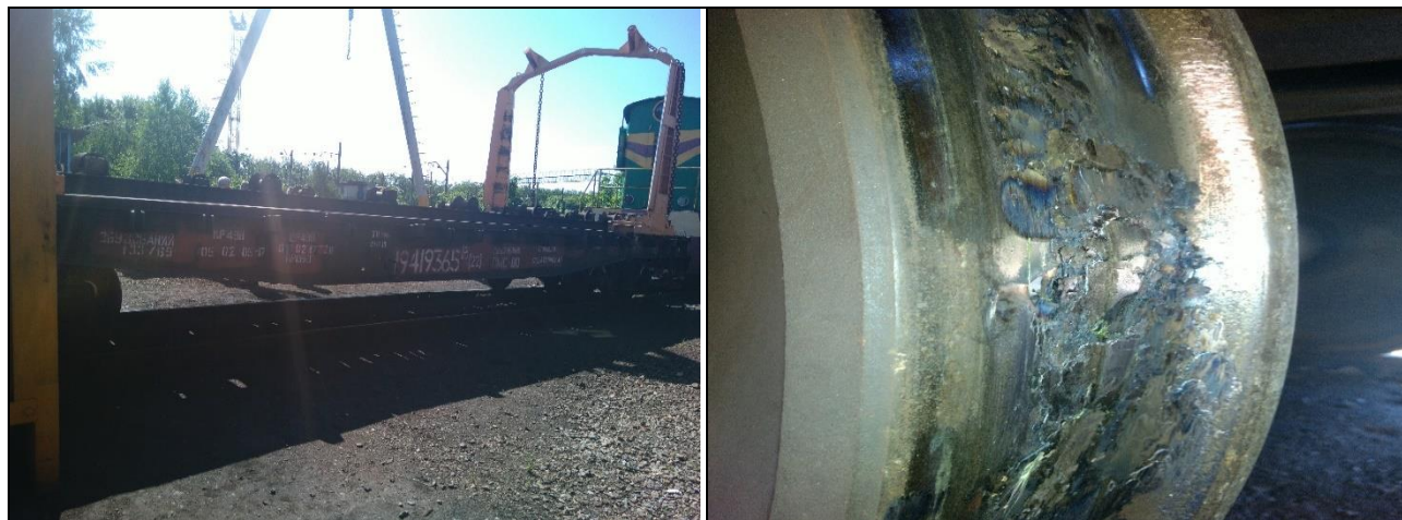
Рисунок 2.5 - Дефекти на поверхнях кочення коліс
