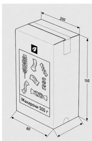
Рис. 1.2. Конструктивна схема картонної коробки прямокутної форми з розмірами (200 × 150 × 80 мм, 500 г)
