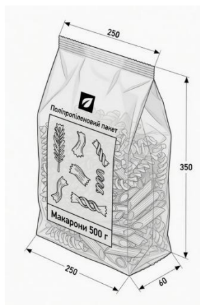
Рисунок 1.3 – Поліпропіленовий (або поліетиленовий) пакет для макаронних виробів з розмірами (250 × 350 × 60 мм, 500 г)
