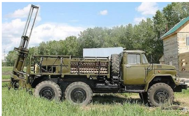
Рис 5.7 Бурова установка БГМ-1
