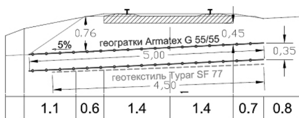
Рис. 6. Схема армування основи баластної призми геосинтетичними матеріалами
