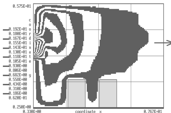
Рис. 8. Зона загрязнения в помещении, t = 26 с (сечение y = 3,6 м)
