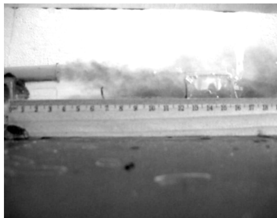
Рис. 7. Распространение загрязненной струи «шахтных» вод в лотке (есть перепад плотности между несущей средой и вторичным потоком)
