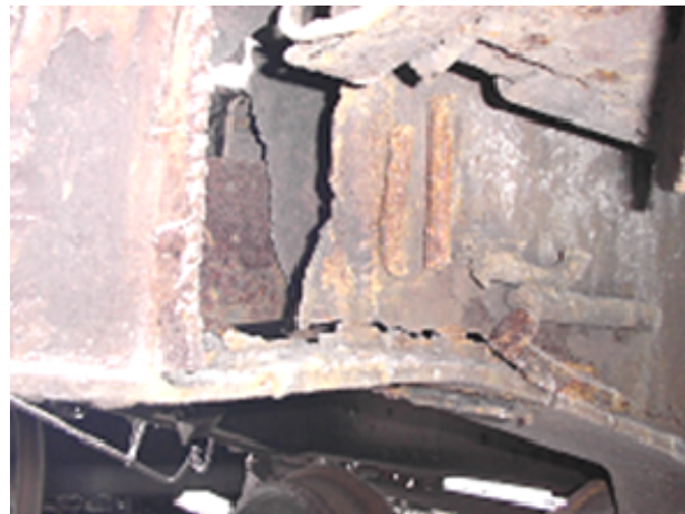
Рис. 6. Відрив вертикального листа шворневої балки від стійки
