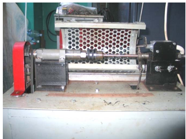
Рис. 7. Положення випробувального зразку у випробувальному стенді
