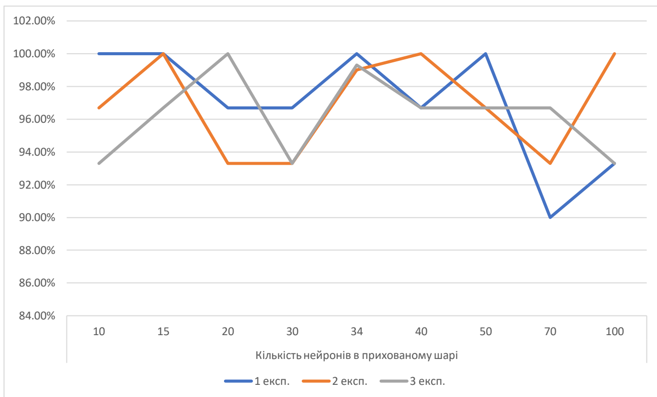
Рисунок 3.7 – Графік залежності ефективності ШНМ від кількості нейронів в прихованому шарі, варіант розподілу по вибірках 80-10-10
