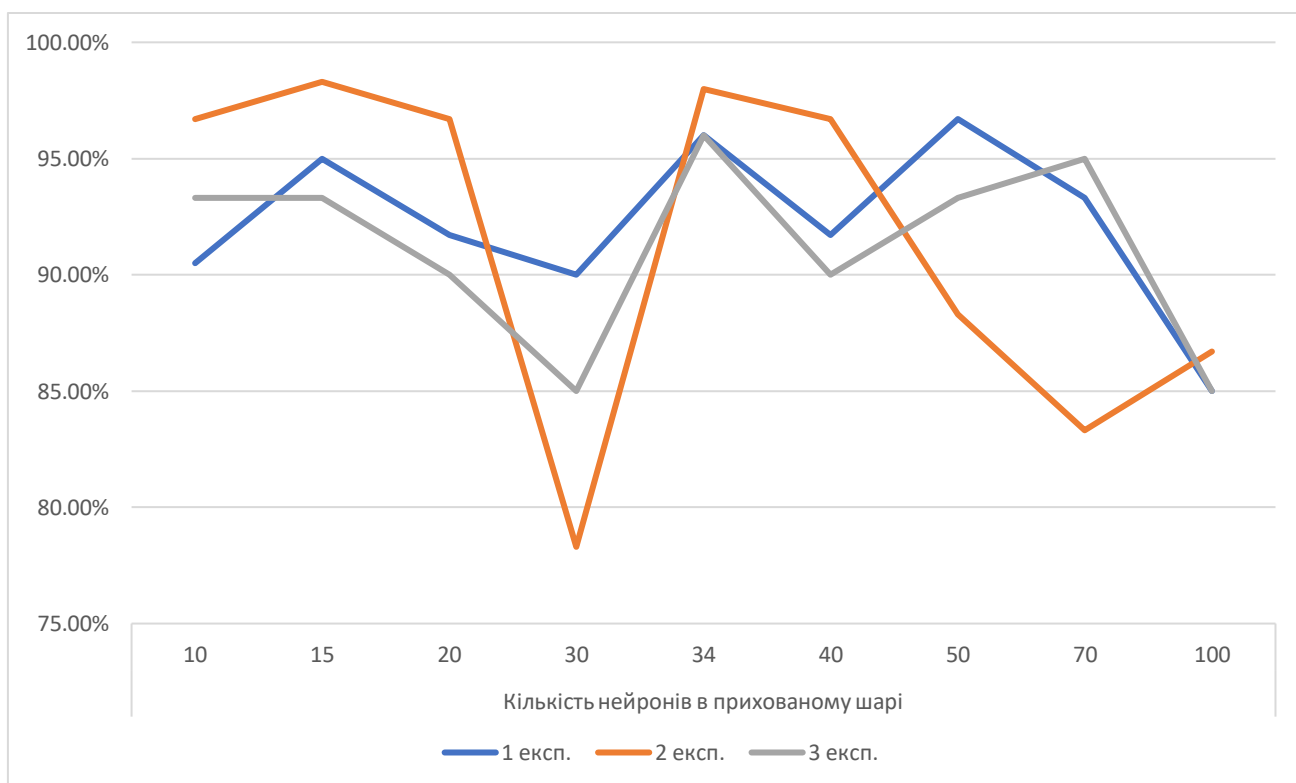
Рисунок 3.6 – Графік залежності ефективності ШНМ від кількості нейронів в прихованому шарі, варіант розподілу по вибірках 40-30-30
