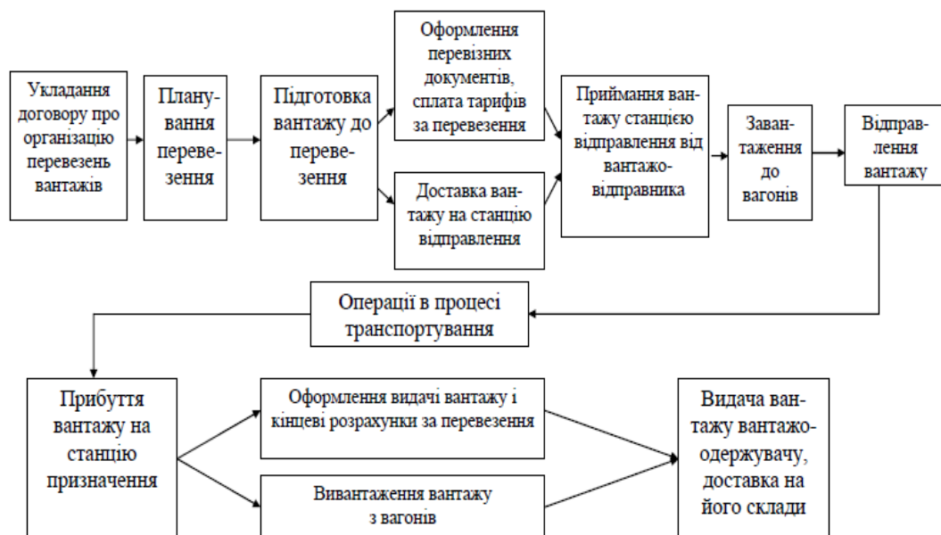
Рисунок 2.1 - Принципова схема перевізного процесу вантажів на залізничному транспорті
