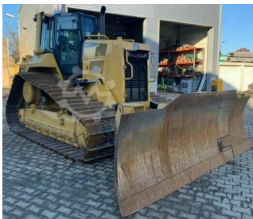
Рис. 1.13. Двосекційний поворотний відвал бульдозера Caterpillar D6K LGP
