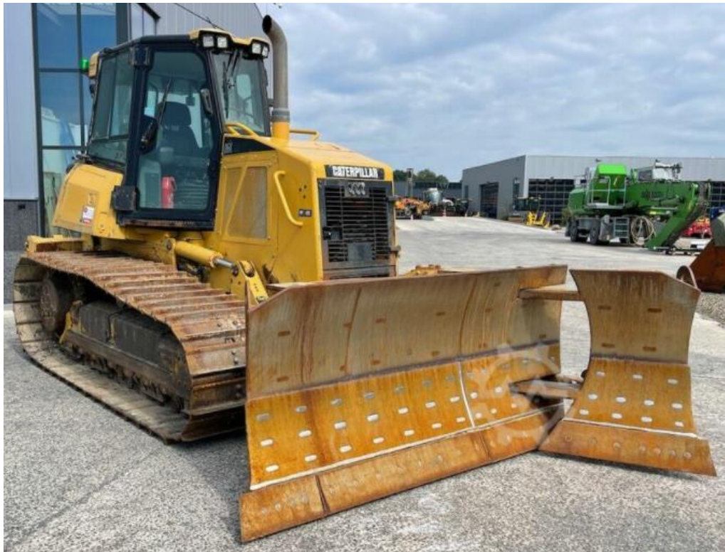
Рис. 1.11. Двосекційний поворотний відвал бульдозера Caterpillar D6K LGP
