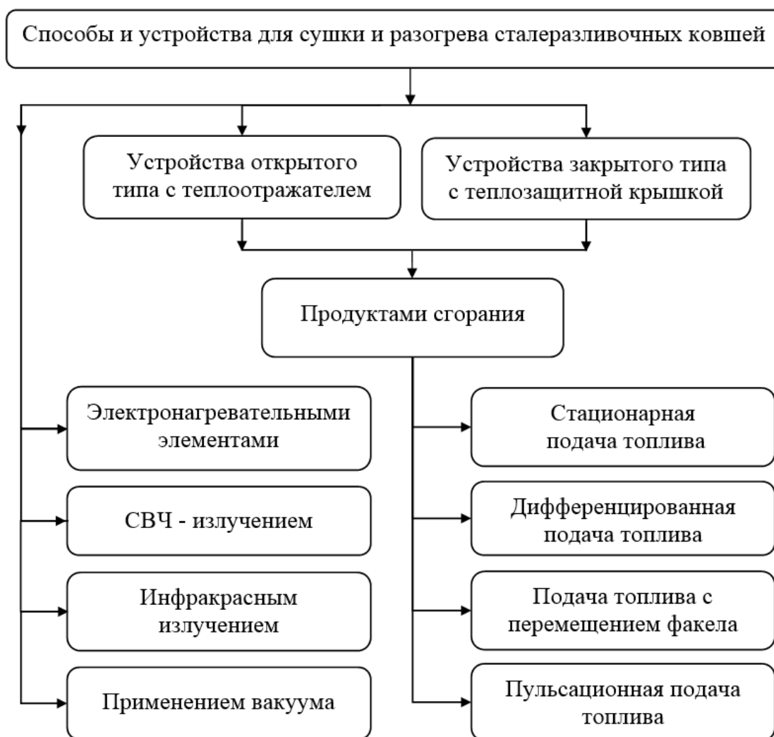
Рис. 1. Способы и устройства для сушки и разогрева сталеразливочных ковшей
