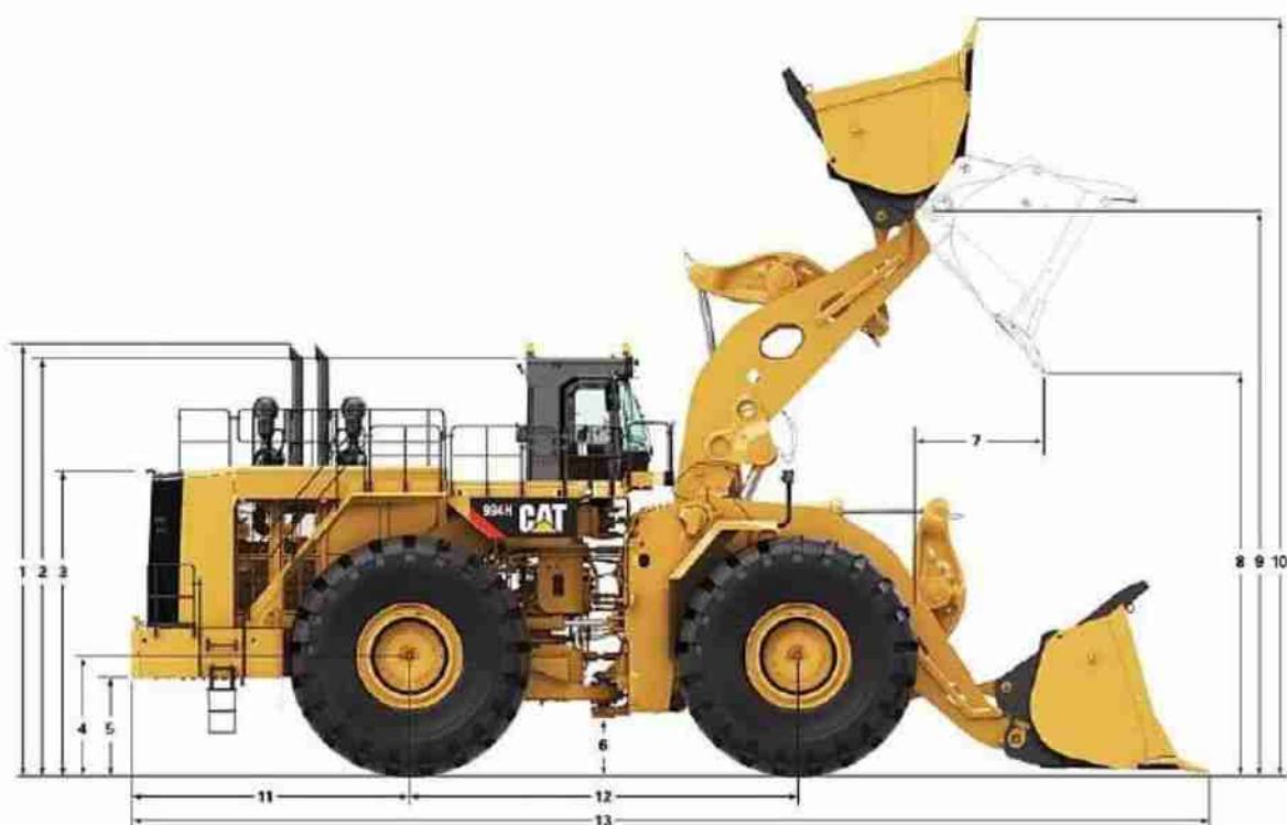
Рис. 3.1. Параметри фронтального навантажувача CAT 994К [21]
