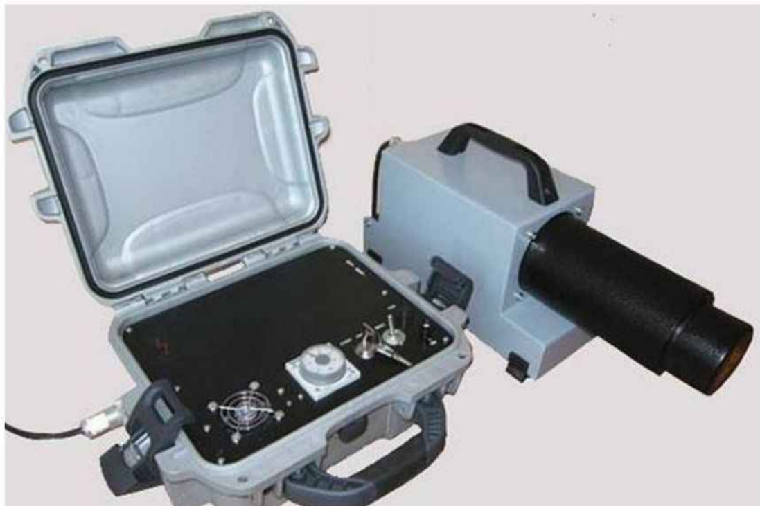
Рис. 4.8 Обладнання для радіаційного методу контролю зварювання
