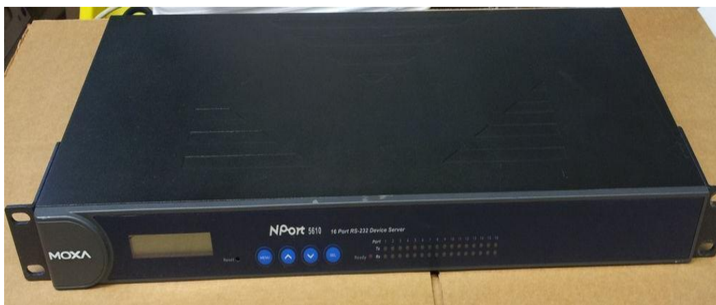
Рисунок 2.16 – Сервер доступу для пристроїв з послідовним інтерфейсом Serial – Ethernet NPort 5610/5630
