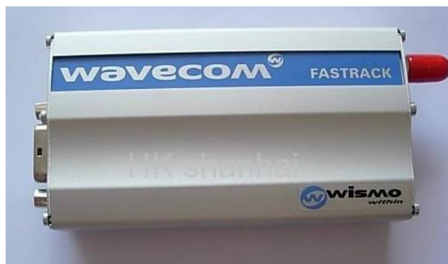
Рисунок 2.14 – Зовнішній вигляд GSM-модему «Fastrack» M1206B
