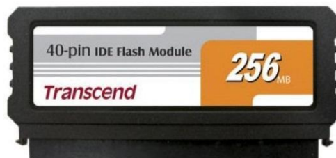
Рисунок 2.11– Flash-диск з інтерфейсом IDE (IDEFlashDrive)
