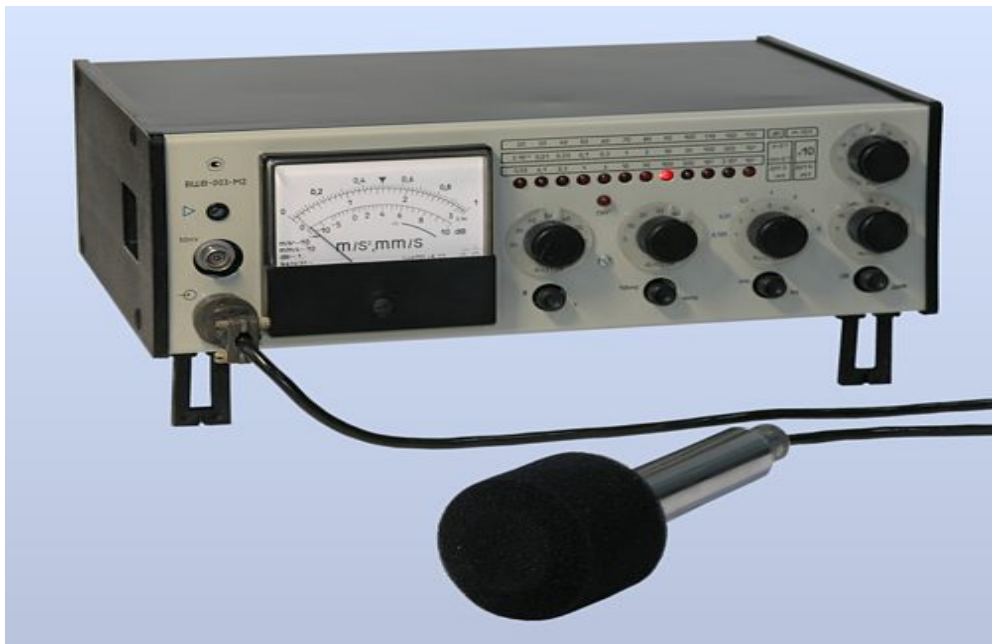
Рисунок 6 – Загальний вигляд шумоміра ВШВ-003
