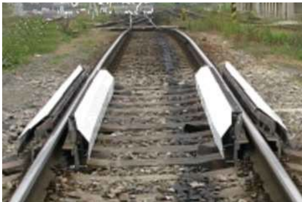
Рисунок 13 – Система Bremex-Annsys фірми Elra для гіркових сповільнювачів
