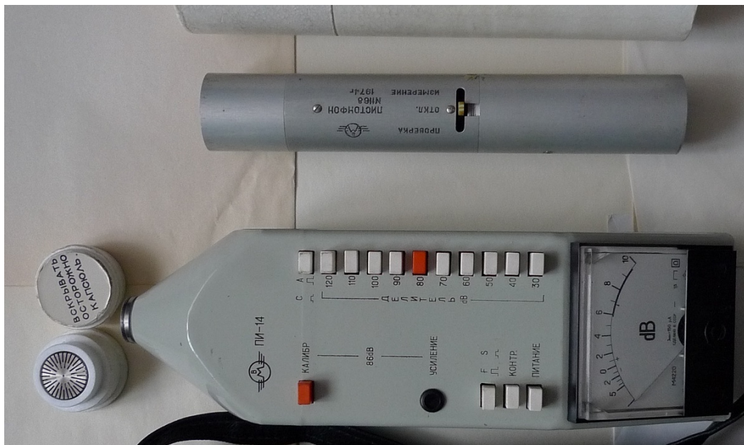
Рисунок 5 – Шумомір ШМ -1 з мікрофонним капсулем та контролером
