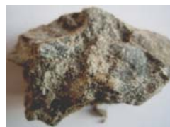
Рис. 8. Глинисті прошарки в структурі бетону шпал
