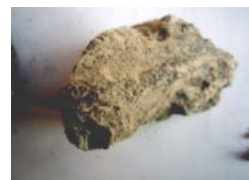
Рис. 8. Глинисті прошарки в структурі бетону шпал
