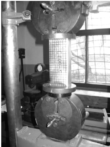
Рис. 2. Випробування на стиск коротких стійок С-подібних профілів
