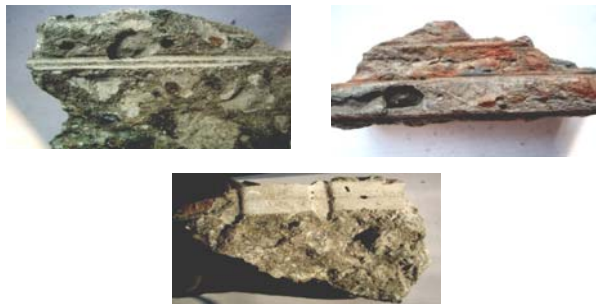
Рис. 5. Каверни та пустоти в структурі шпал, що експлуатуються
