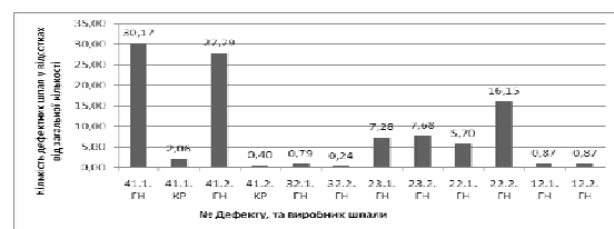
Рис.15. Діаграма, що показує кількість дефектів одного типу від загальної (1266 шт., що зазначені в колійних журналах) та виробника дефектних шпал
