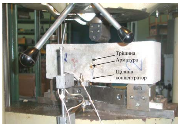
Рис. 4. Випробування бетонного зразка з прутком арматури зосередженим згином на установці EUS-20
