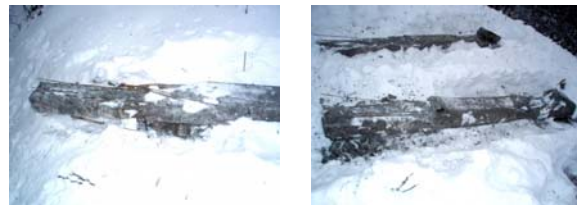
Рис. 3. Шпали 2005 року виготовлення, вилучені з експлуатації на Південно-західній залізниці
