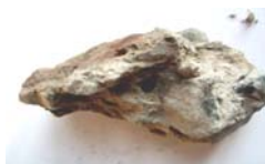
Рис. 7. Зразки зломів бетону шпал
