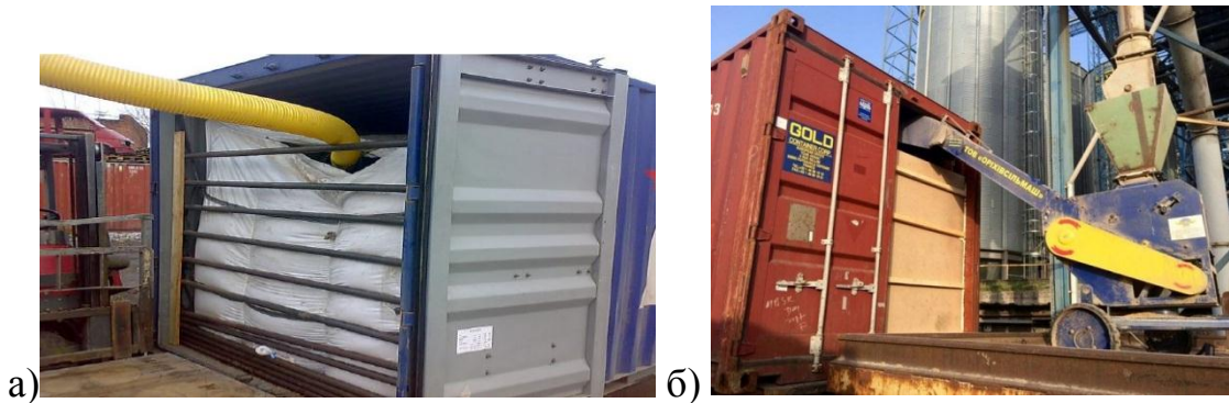
Рисунок 2.8 – Завантаження зерна в контейнер з використанням: а) пневматичного навантажувача; б) стрічкового конвеєра
