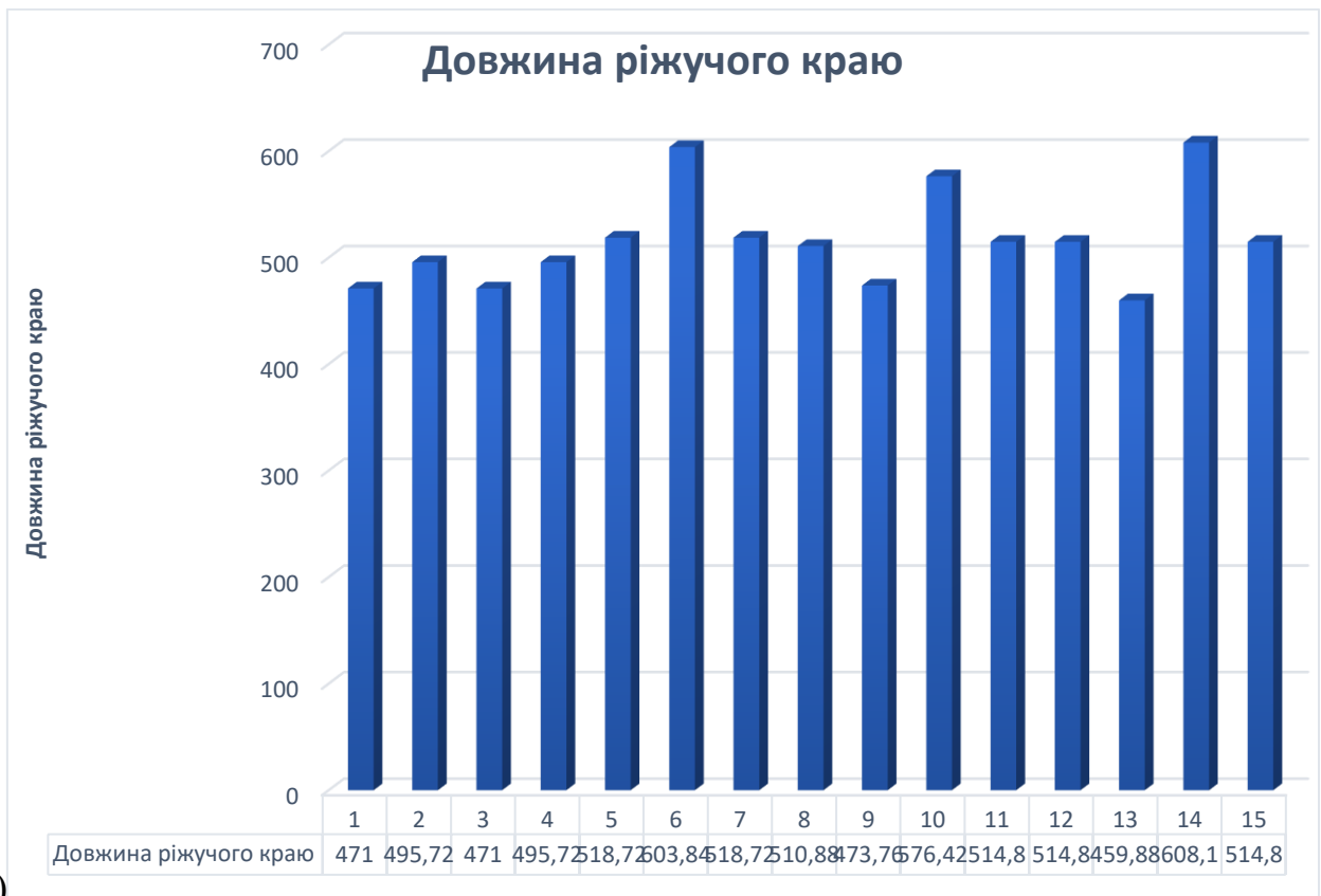
а – вага моделей ПНС; б – довжина ріжучого краю моделей ПНС; Рис. 4.9. Параметри моделей ПНС які працюють в горизонтальній площині
