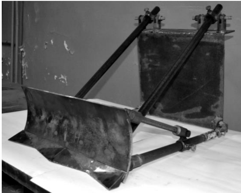
Рис. 4.4. Бульдозерне обладнання з ПНС для дослідження процесу взаємодії з ґрунтом
