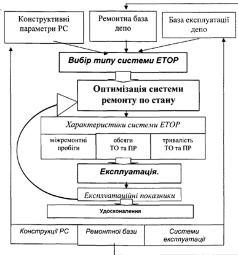
Рисунок 2.4 – Адаптивна модель системи ЕТОР для нових маневрових тепловозів
