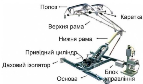
Рисунок 3.1 – Основні складові струмоприймача (пантографа)
