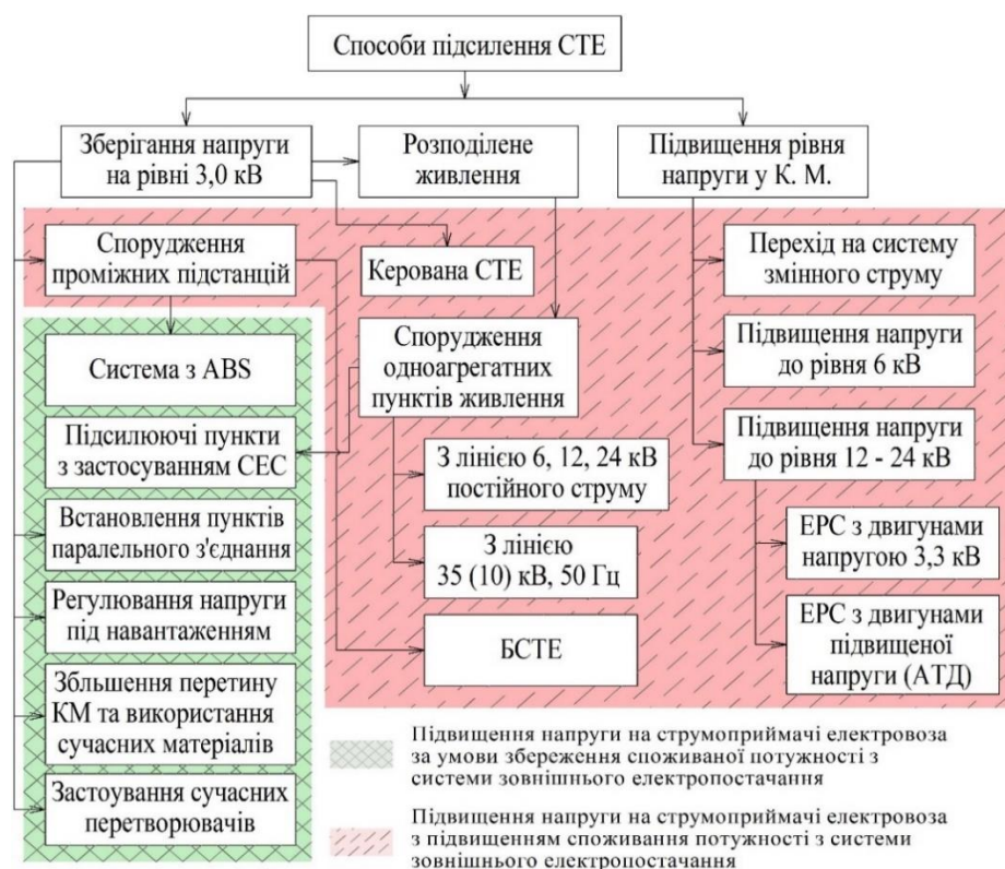
Рисунок 3.1 - Способи підсилення системи тягового електропостачання постійного струму
