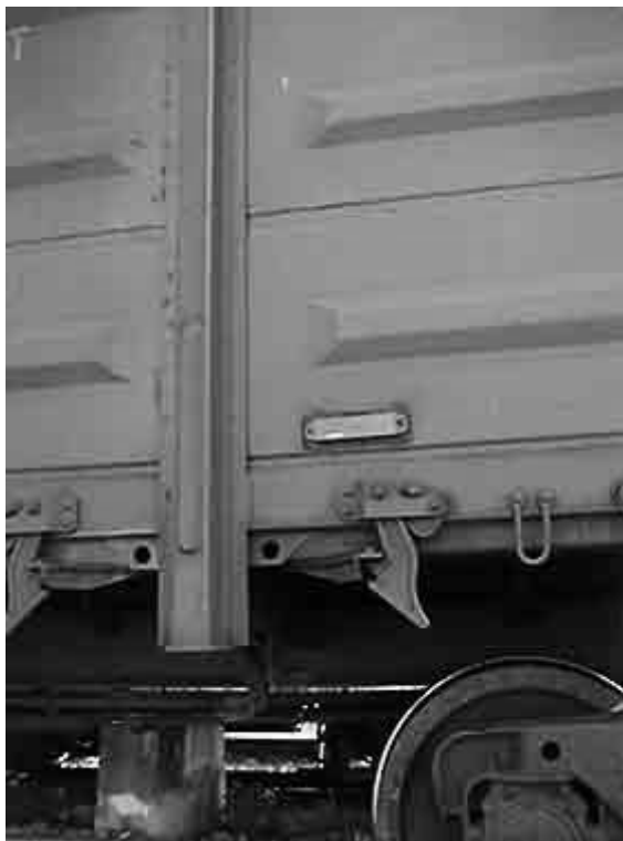
Рисунок 1.2 – Кодовий бортовий датчик
