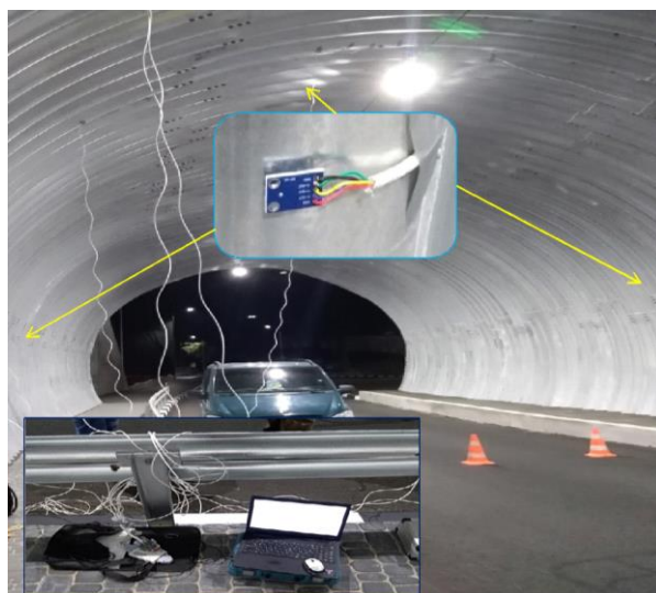
Рис. 1.24. Процес проведення експериментальних інерційних випробувань металевих гофрованих конструкцій шляхопроводу
