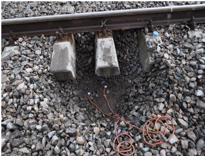
Рис. 1.4. Встановлення месдоз в баластному шарі залізничної колії
