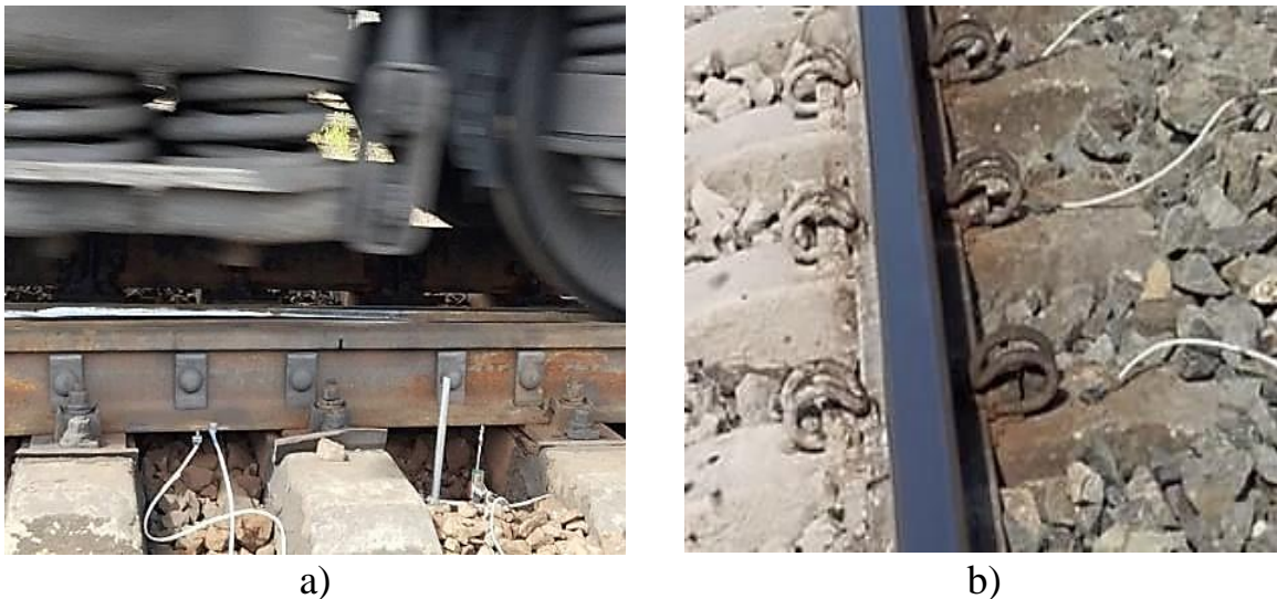
Рис. 1.5. Встановлення акселерометрів: а) на підшві рейки; б) на поверхні шпали
