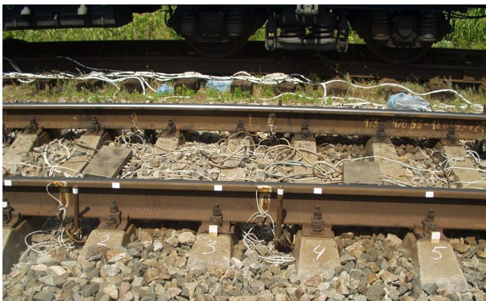
Рис. 1.1. Залізнична ділянка з встановленими на рейках тензометричними датчиками
