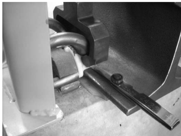
Рис. 3.49. Метод вимірювання сили притискання пружної клєми скріплення в колії
