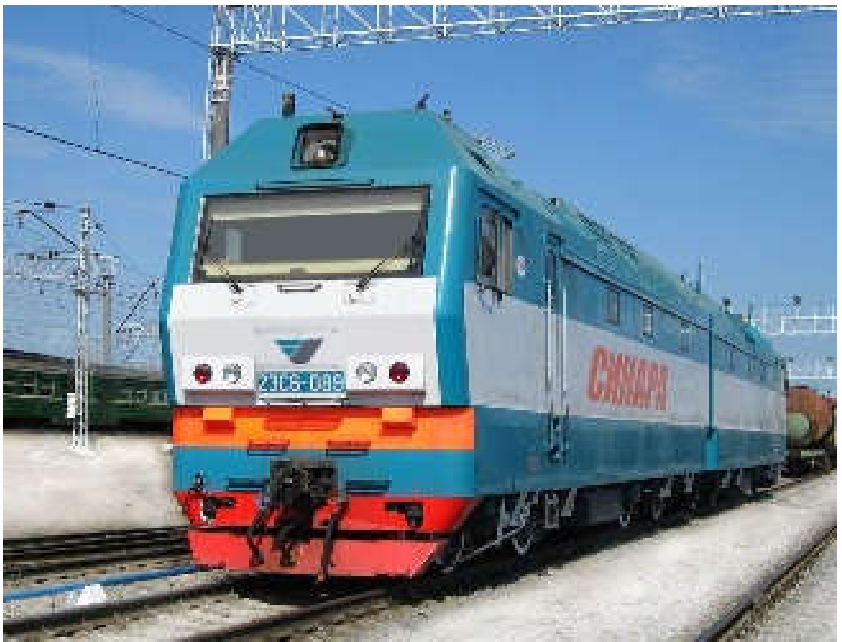
Рисунок 3.5 – Електровоз постійного струму 2ЕС6.
