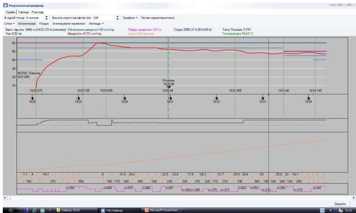
Рисунок 5.12 - Розрахунок графіка руху поїзда з електровозом ВЛ11м із максимальною масою 1350т
