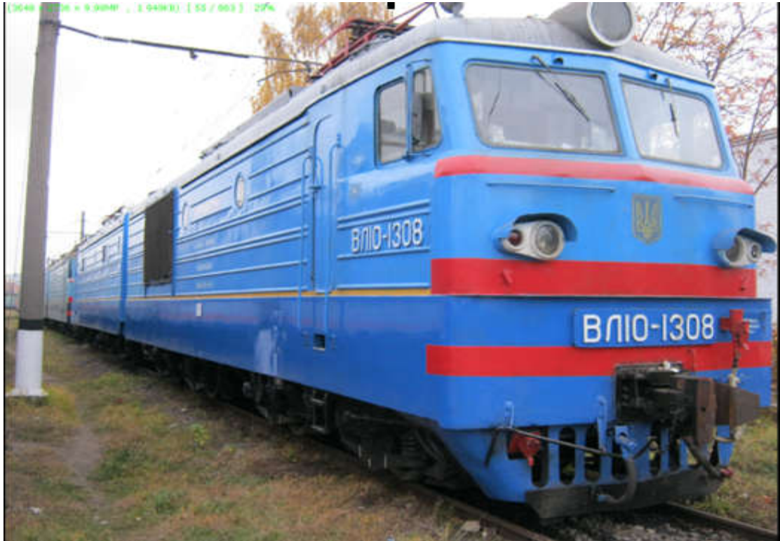
Рисунок 3.1 – Магістральний вантажний електровоз серії ВЛ10 постійного струму.
