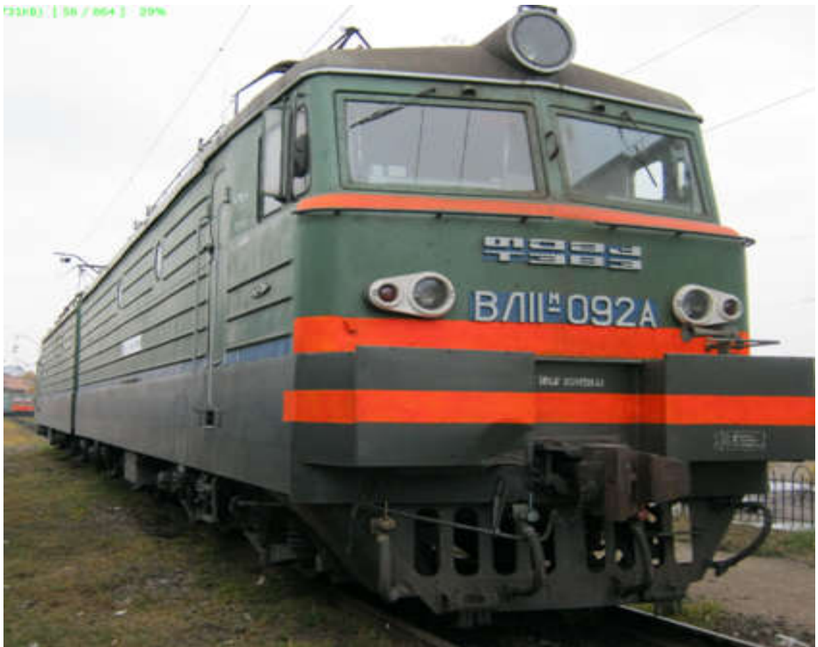
Рисунок 3.3 – Магістральний вантажний електровоз серії ВЛ11м постійного струму.
