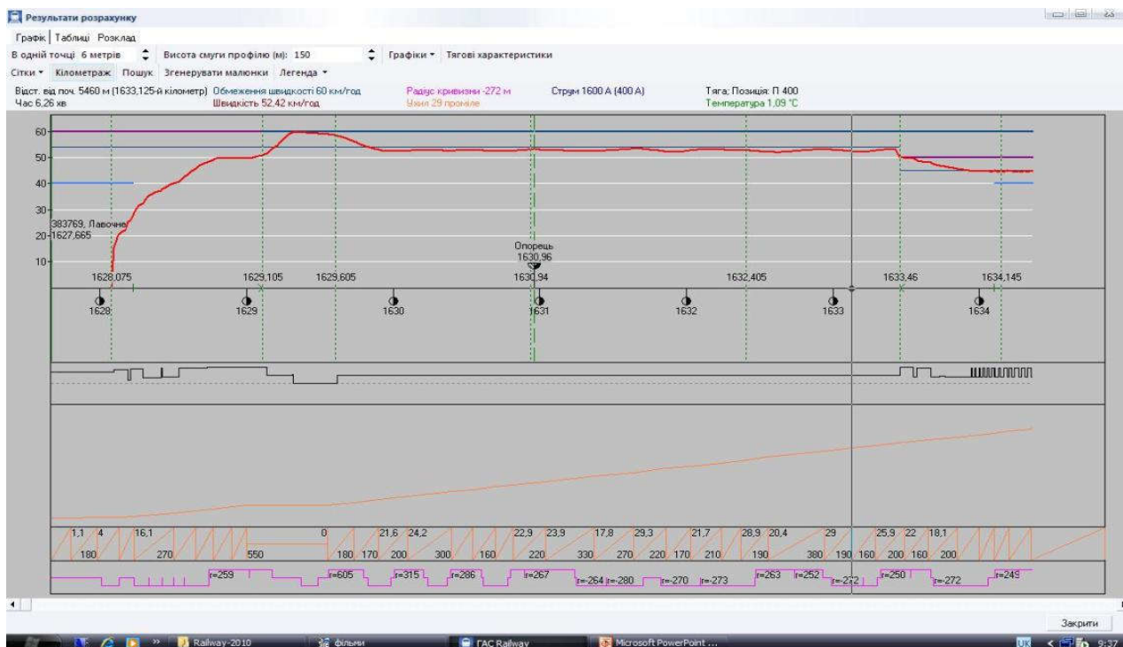
Рисунок 5.16 - Розрахунок графіка руху поїзда з електровозом 2ЕС6 із встановленою масою 1200т
