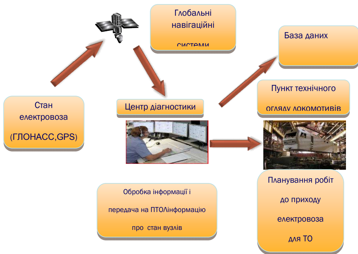
Рисунок 3.8 – Система безвідривного контролю за електровозами ВАТ «Уральський завод залізничного машинобудування»
