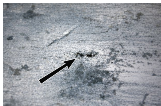
Рисунок 3 - Сліди корозії а) і пітингового зносу б) на робочій поверхні поршня (збільшення 1080х)
