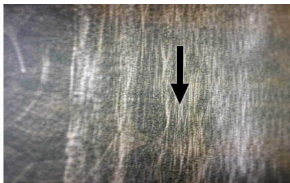
Рисунок 4 - Макроструктура сферичної поверхні поршня зі слідами гідроабразивного зношення (збільшення 1080х)
