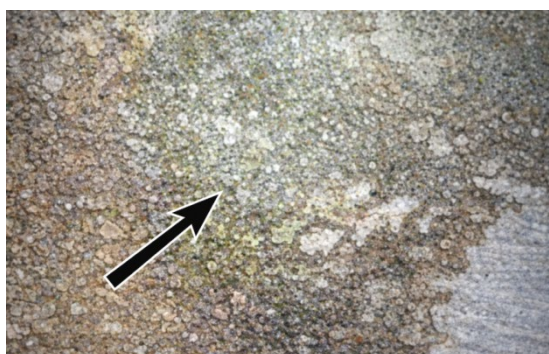
Рисунок 3 - Сліди корозії а) і пітингового зносу б) на робочій поверхні поршня (збільшення 1080х)
