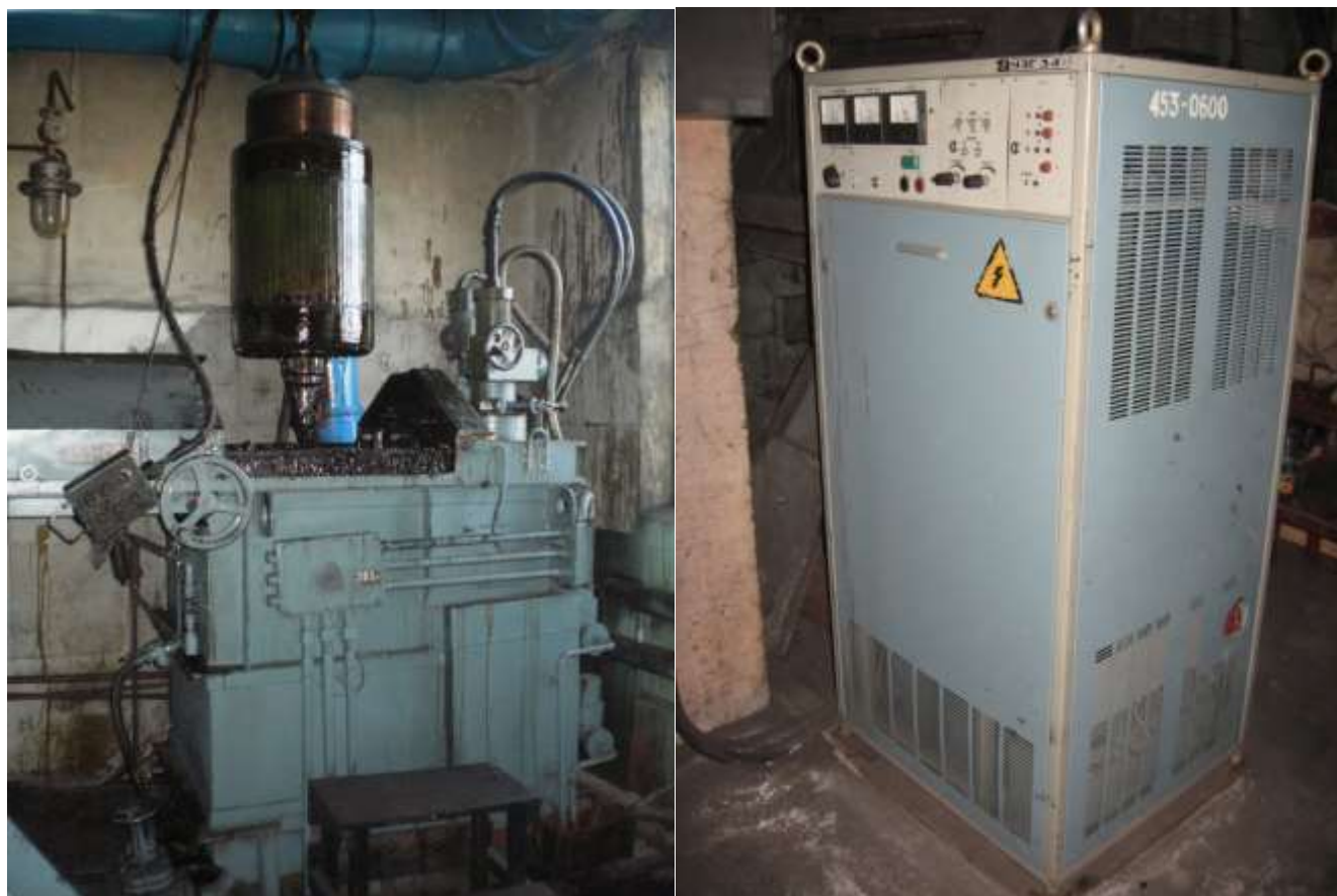
Рисунок 2.1 – Загальний вид установки для ультразвукового просочення якорів тягових електродвигунів
