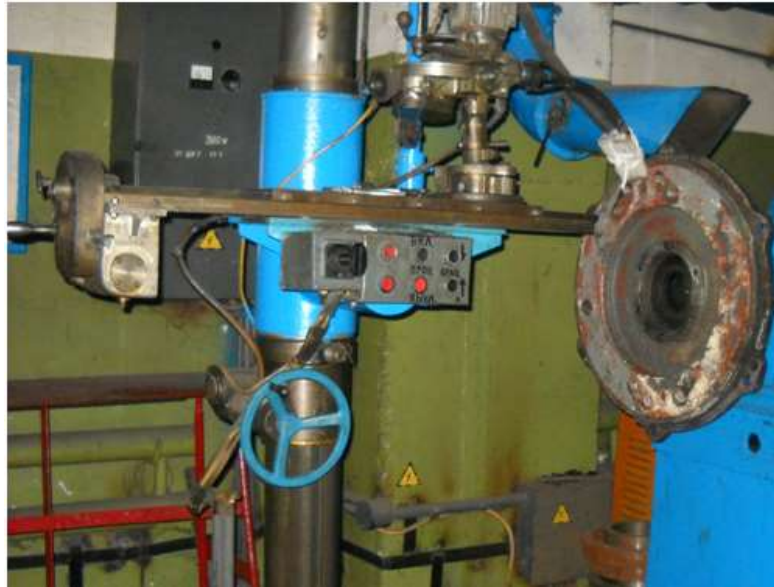
Рисунок 1.11 – Загальний вид установки для наплавлення підшипникових щитів тягових електродвигунів
