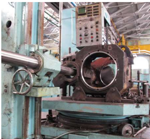
Рисунок 1.10 – Розточка остова електродвигуна під підшипникові щити та моторно-осьові підшипники
