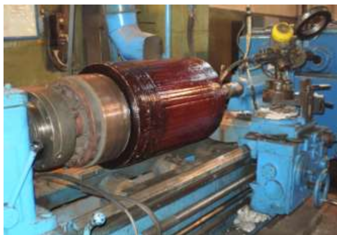
Рисунок 1.9 – Установка вібродугової наплавка вала якоря електродвигуна
