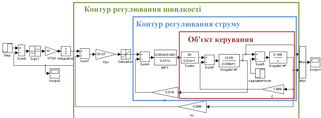
Рисунок 2 – Схема моделі системи підлеглого регулювання в Matlab/Simulink з двома контурами регулювання: струму ( I ) та швидкості обертання двигуна ( \omega )
